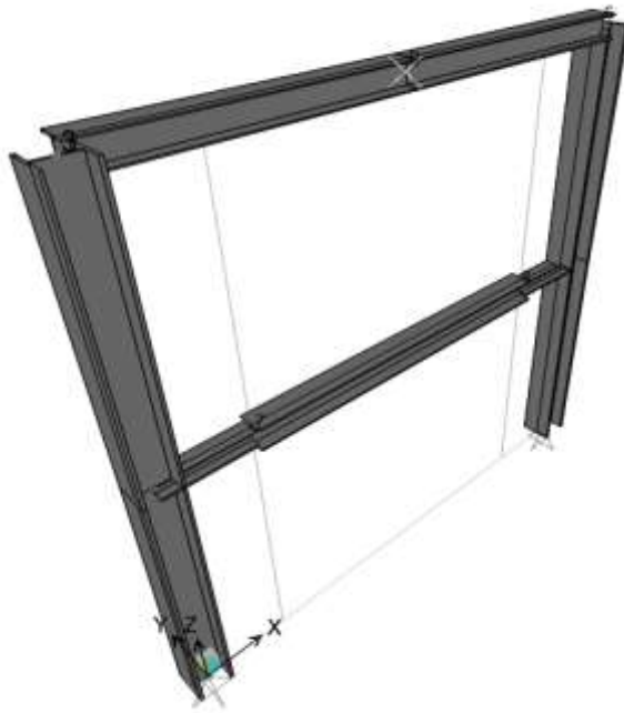
Εικόνα 3.6 : Τρισδιάστατη μορφή των διατομών του μεταλλικού πλαισίου.
