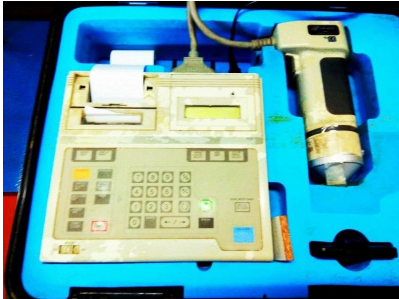
Εικόνα 3: Χρωματόμετρο CR-200 των εταιριών Konica-Minolta
