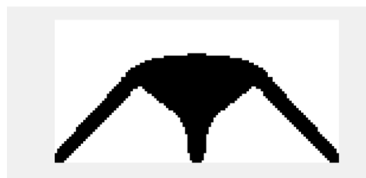
Εικόνα 5.4: Λύση Level Set μεθόδου για 120x60
