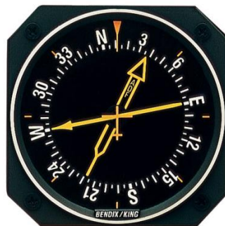
Εικόνα 2.11: Ένδειξη πιλοτηρίου για το NDB
