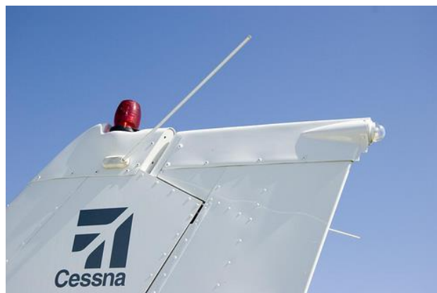
Εικόνα 2.14: Κεραία VOR επί του αεροσκάφους
