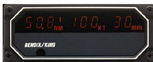
Εικόνα 2.8: Ένδειξη οργάνου DME εντός πιλοτηρίου
