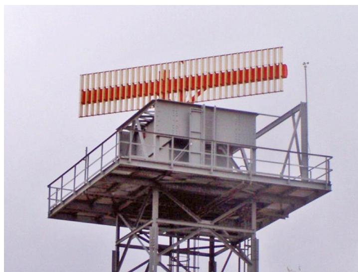
Εικόνα 2.30: Κεραία δευτερεύοντος ραντάρ SSR στο Νοϊμπράντενμπουργκ
