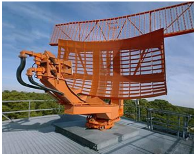
Εικόνα 2.33: Συνδυασμένο πρωτεύον και δευτερεύον ραντάρ
