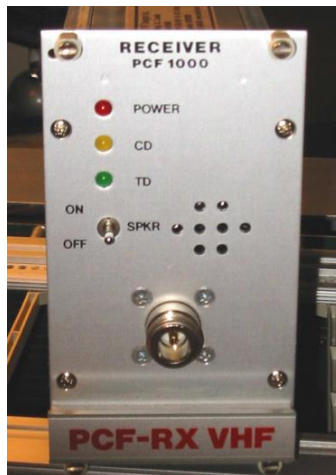
Εικόνα 2.6: Δέκτης σημάτων εντός αεροσκάφους
