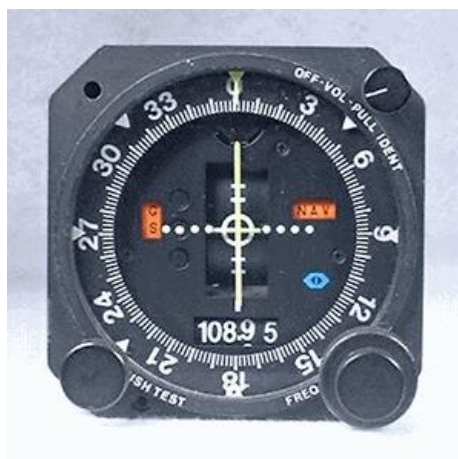
Εικόνα 2.21: Ένδειξη οργάνου ILS του πιλοτηρίου
