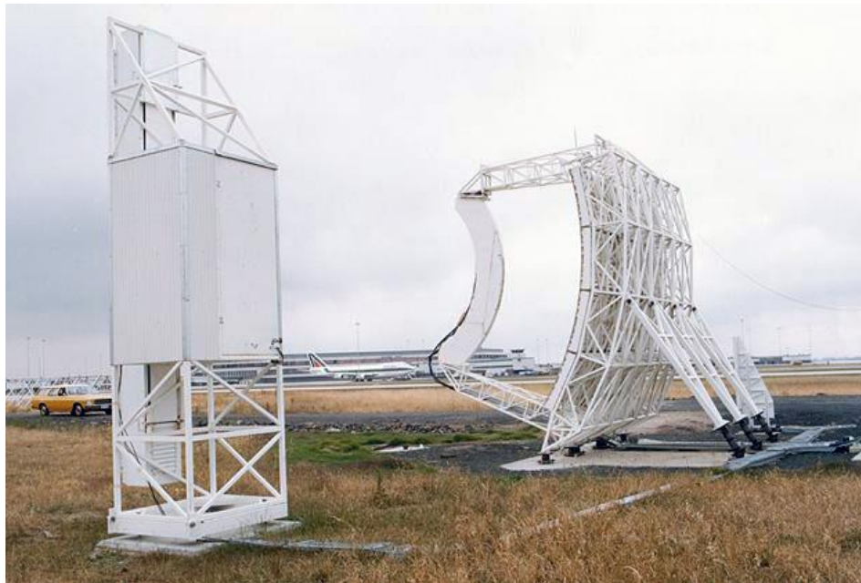
Εικόνα 2.24: Καθοδηγητής ανύψωσης (αριστερά) και καθοδηγητής αζιμούθιου (δεξιά) MLS στο αεροδρόμιο της Μελβούρνης
