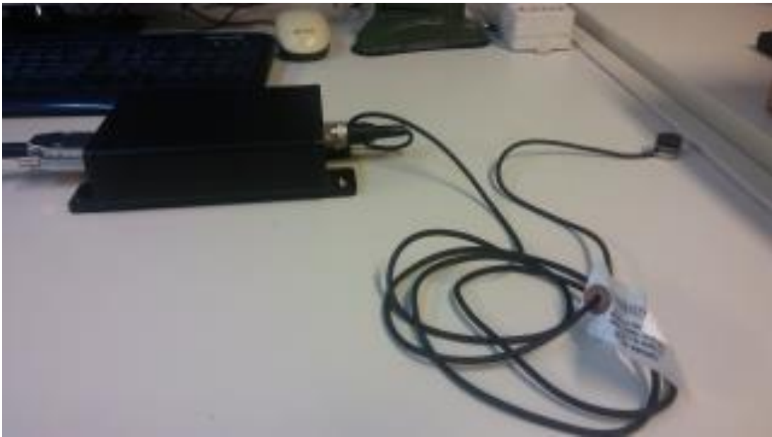
Σχήμα C.4. Συνδεσμολογία κουτί τροφοδοσίας με τον αισθητήρα.
