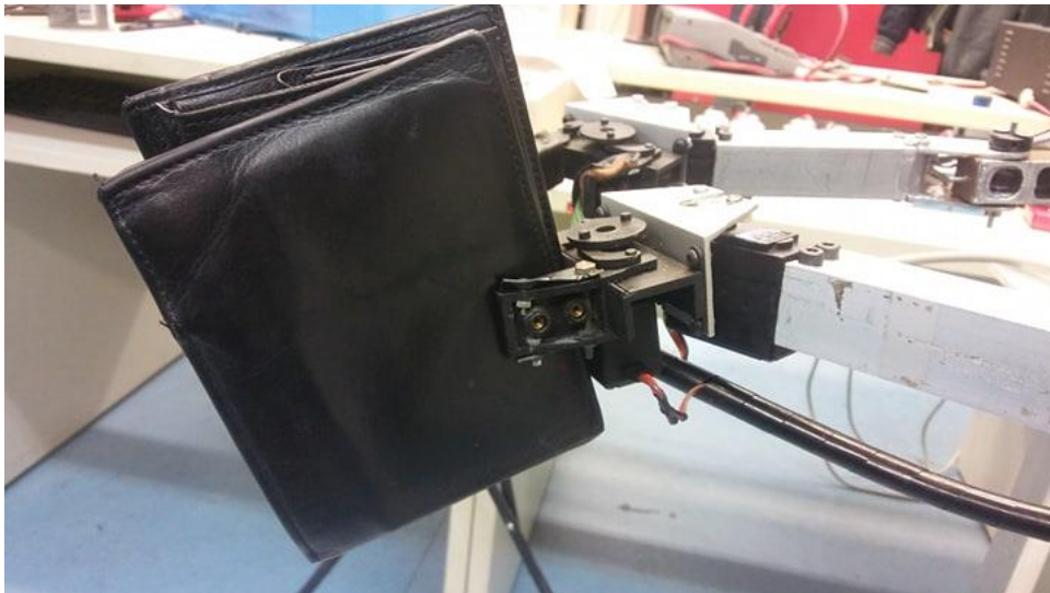
Σχήμα 3.53. Το σύστημα αρπάγης κρατώντας δοκιμαστικά ένα αντικείμενο με κάποια ευκαμψία.
