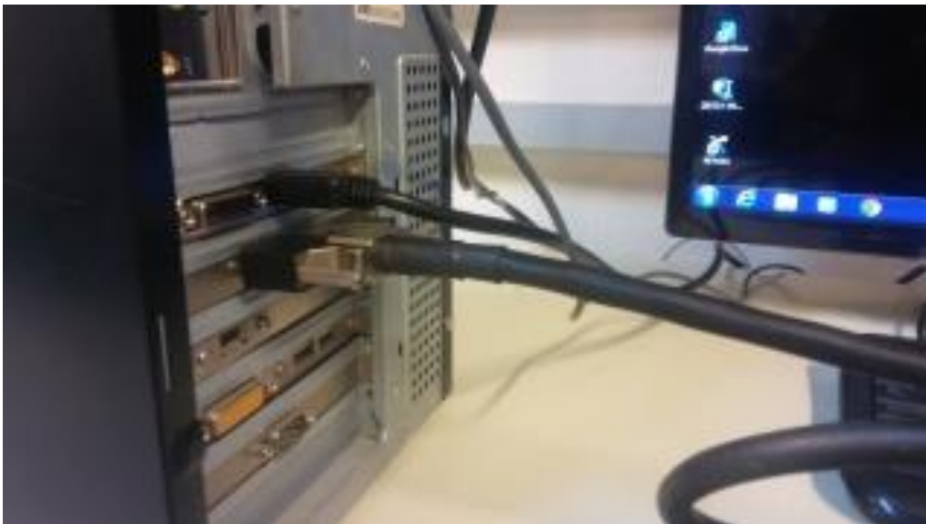
Σχήμα C.2. Συνδεσμολογία κάρτας αισθητήρα με κουτί τροφοδοσίας (1).
