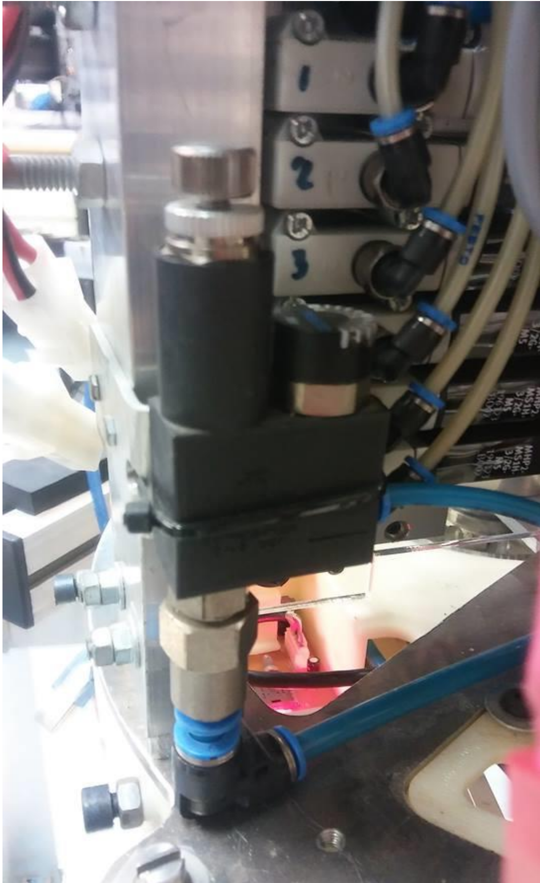
Σχήμα 4.5. Ρυθμιστής πίεσης από τον οποίο παρέχεται αέριο στα αερόδρανα.
