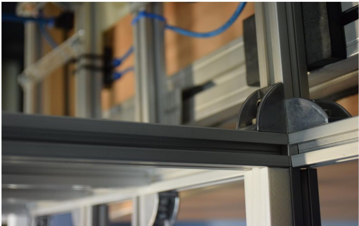
Σχήμα 6.3. Πλαίσια αλουμινίου με κενά V του παθητικού ρομπότ, στα οποία τοποθετούνται τα στηρίγματα του στεφανιού.
