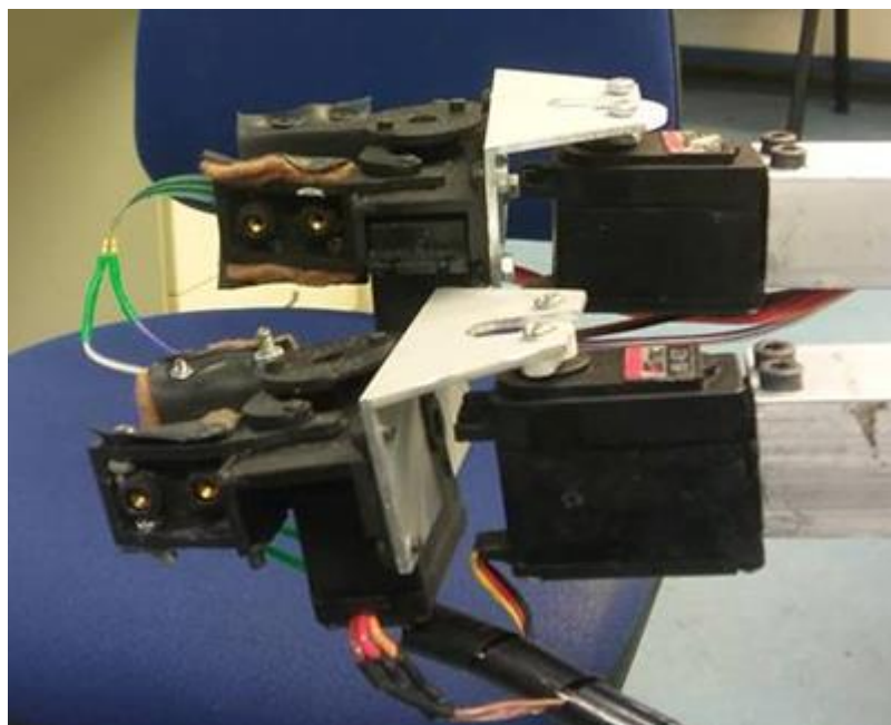
Σχήμα 3.22. Σύγκριση κάμψης των δύο βραχιόνων μετά την προσθήκη αρπάγης. Πίσω εικονίζεται ο νέος και μπροστά ο παλιός.
