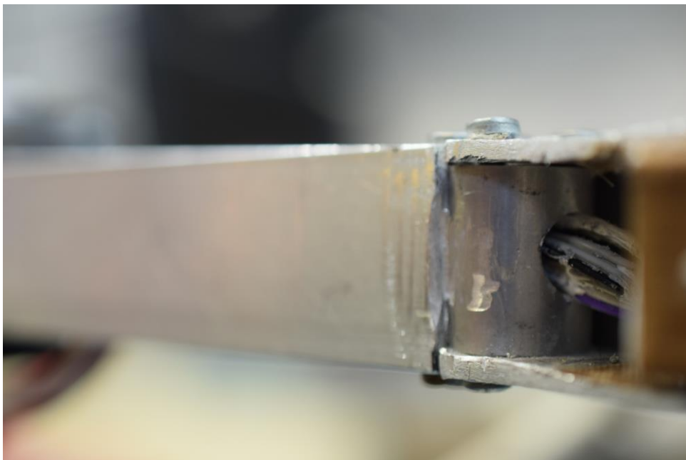
Σχήμα 3.24. Έξοδος καλωδίων αρπάγης και FSR από το εσωτερικό του δεύτερου μέλους του βραχίονα.
