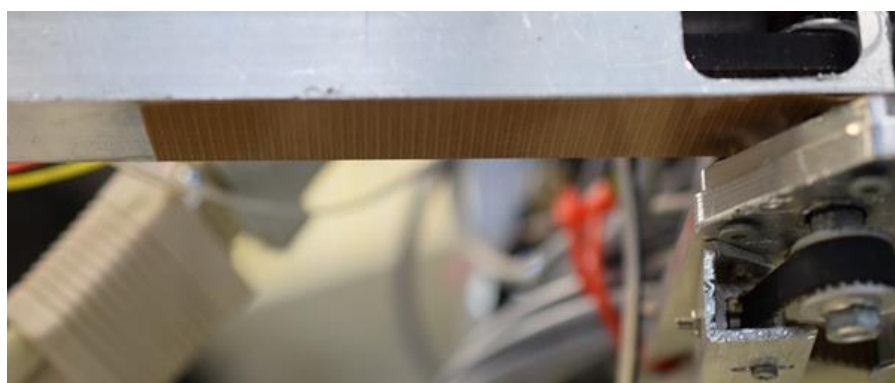
Σχήμα 3.14. Έδραση με τεφλόν εμπλουτισμένο με γυαλί στην πρώτη άρθρωση.
