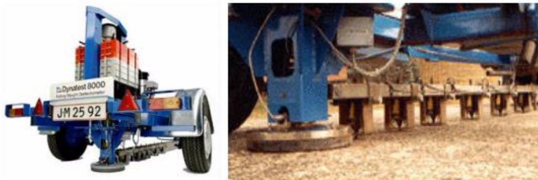
Εικόνα 2.11: Συστήματα επιβολής δυναμικού φορτίου, FWD
