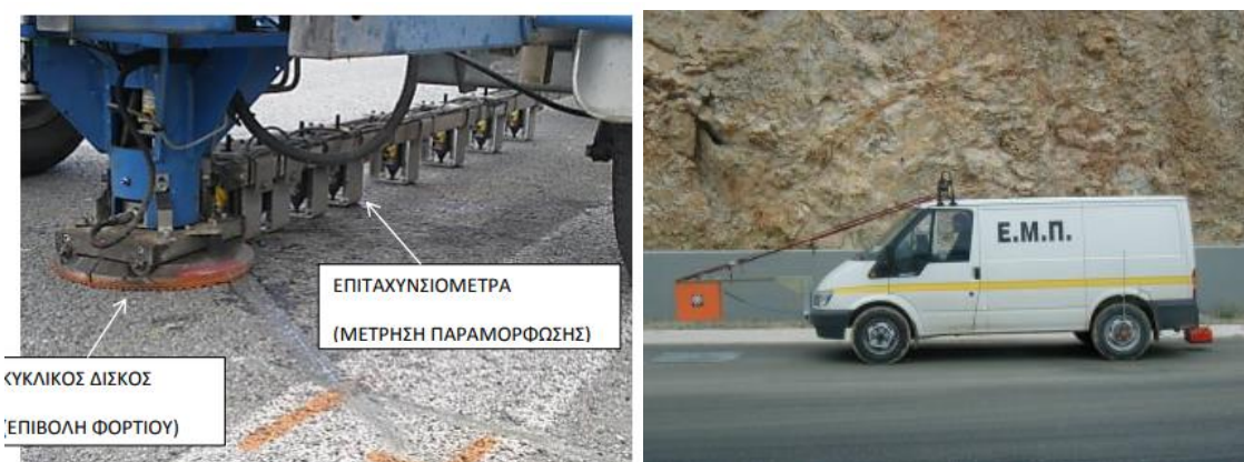
Εικόνα 3.1: Παραμορφωσίμετρο προσπίπτοντος βάρους
