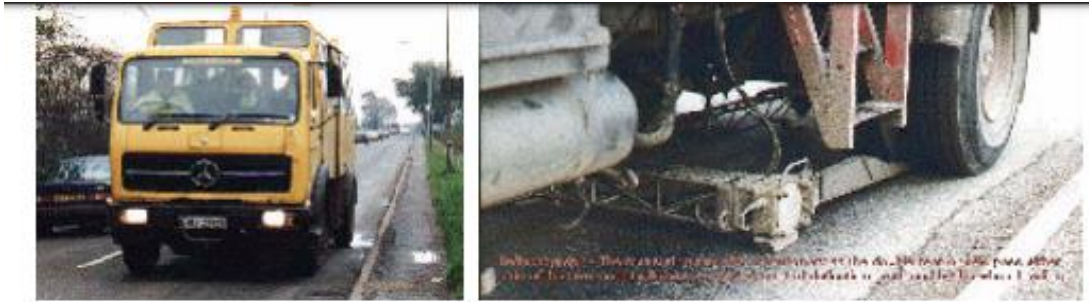
Εικόνα 2.9: Συστήματα επιβολής στατικού φορτίου, deflectograph
