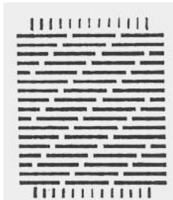
Σχήμα 2.11 Αποτύπωμα πλέξης νημάτων 4 επάνω -1 κάτω.
