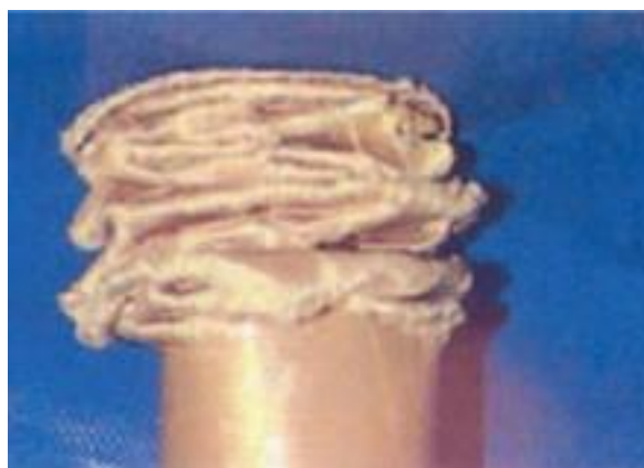
Σχήμα 2.15 Απεικόνιση σύνθετου δοκιμίου που έχει καταρρεύσει με progressive folding τρόπο.
