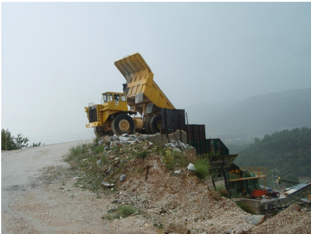
Εικόνα 5.5: Απόθεση εξορυγμένου υλικού στον θραυστήρα
