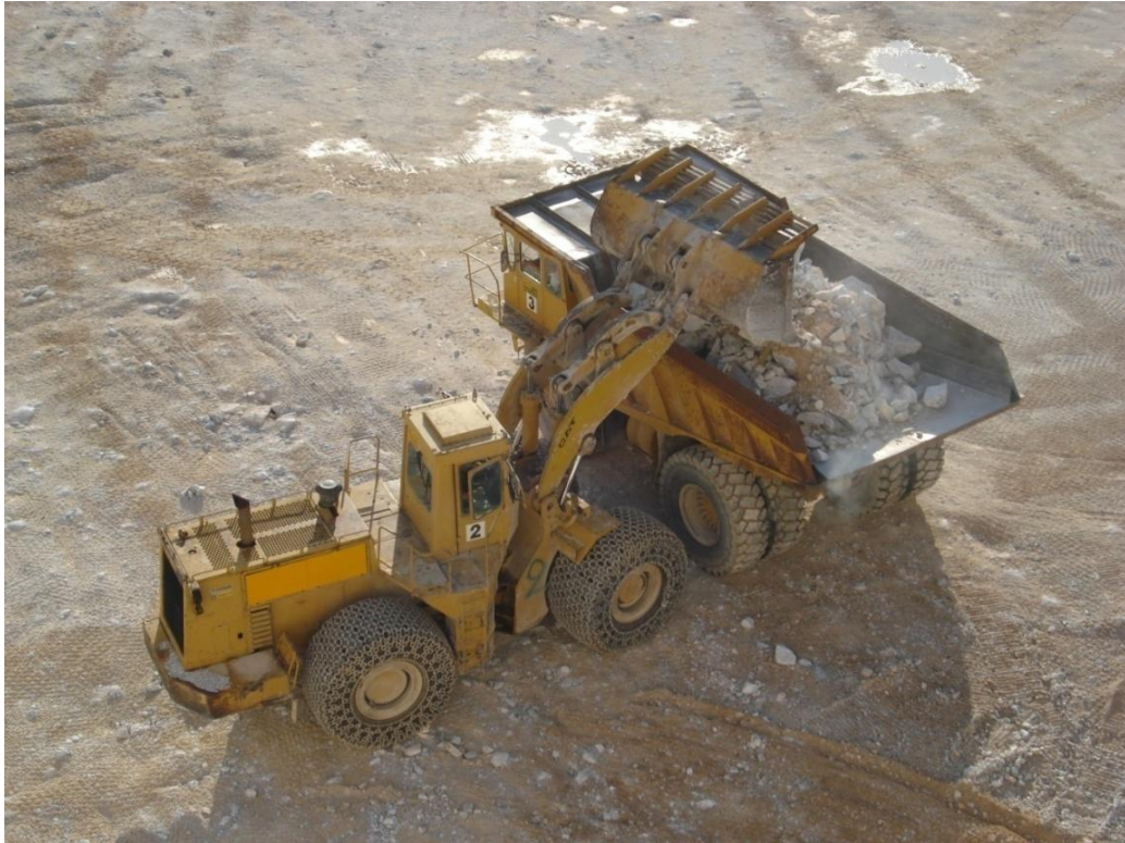
Εικόνα 5.4: Φόρτωση του εξορυγμένου υλικού στα φορτηγά οχήματα.
