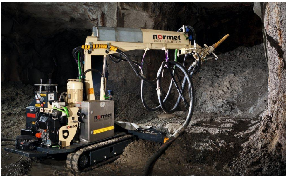
Σχήμα 53. Ρομπότ ψεκασμού σκυροδέματος Minimec της Normet.
