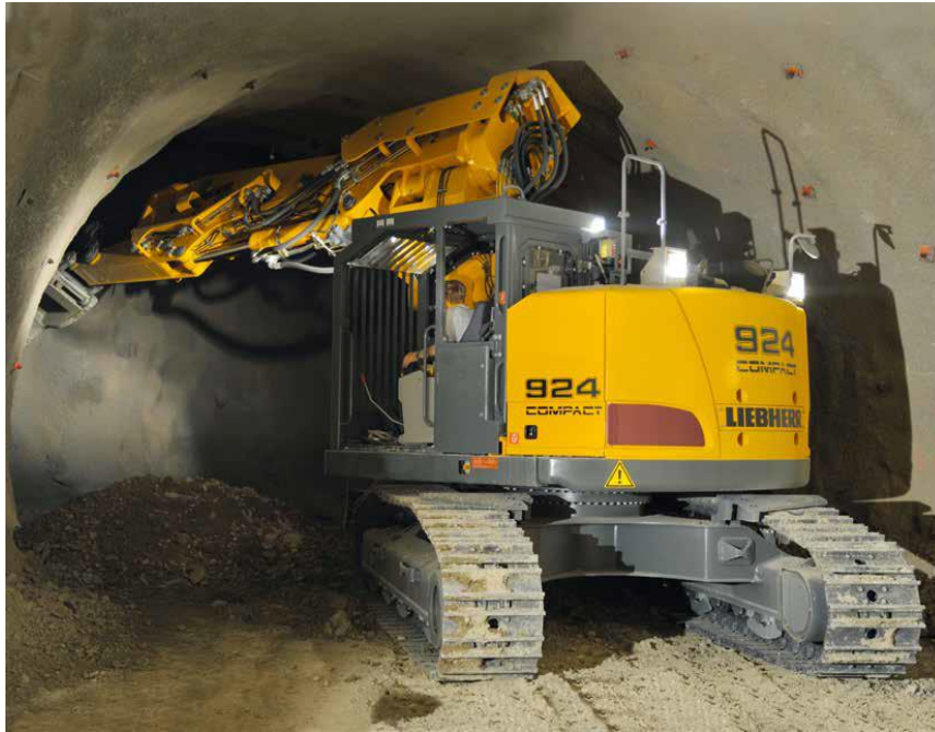
Σχήμα 45. Εκσκαφέας σηράγγων R924C της Liebherr.
