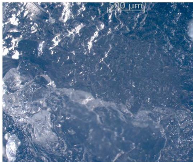
Σχήμα 3.4 Φωτογραφία υγρούματος κολλοειδούς πυριτίας από ηλεκτρονικό μικροσκόπιο
