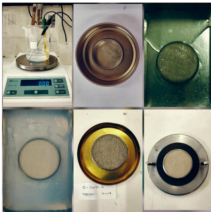
Σχήμα 4.2 Παρασκευή σταθεροποιημένου δοκιμίου CS=10% άμμου M31 α) υγρόλυμα πυριτίας, β) καλούπι συσκευής συμπίεσομέτρου, γ) εμφάπτιση ξηρού εδαφικού υλικού σε υγρόλυμα κολλοειδούς πυριτίας, δ) και ε) σταθεροποιημένο δοκίμιο μετά από ώρες ωρίμανσης, και στ) σταθεροποιημένο δοκίμιο πριν τη φόρτιση.
