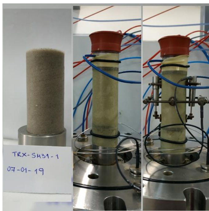
Σχήμα 5.3 Σταθεροποιημένο δοκίμιο CS=10% άμμου M31 α) σταθεροποιημένο δοκίμιο μετά από ώρες ωρίμανσης, β) τοποθέτηση στην τριαξονική συσκευή και γ) τοποθέτηση μηχανομετρών στο δοκίμιο
