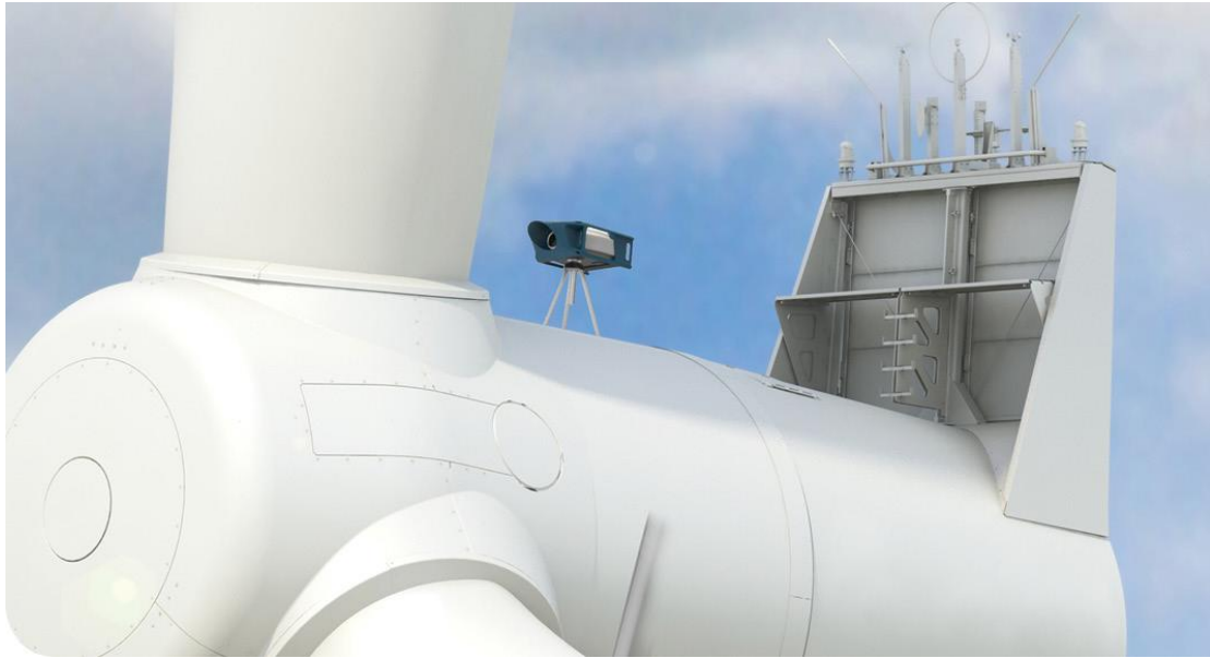
Σχήμα 3.8: LIDAR τοποθετημένο πάνω σε ανεμογεννήτρια.
