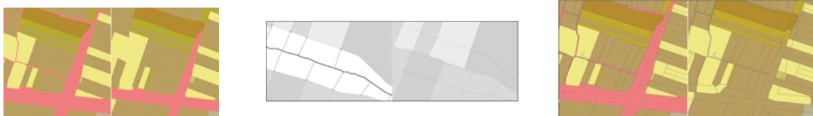
Γράφημα 12: Αποτέλεσμα γενίκευσης οδικού δικτύου Dimon κ.ά., αριστερά αρχικά δεδομένα δεξιά γενικευμένα δεδομένα πηγή: (Dimon κ.ά., 2014)
