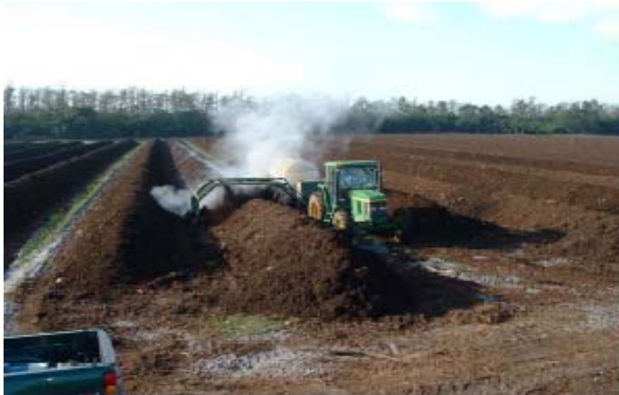
Εικόνα 3.2: Σύστημα αναστρεφόμενων σειραδιών με αυτοκινούμενο αναστροφέα
