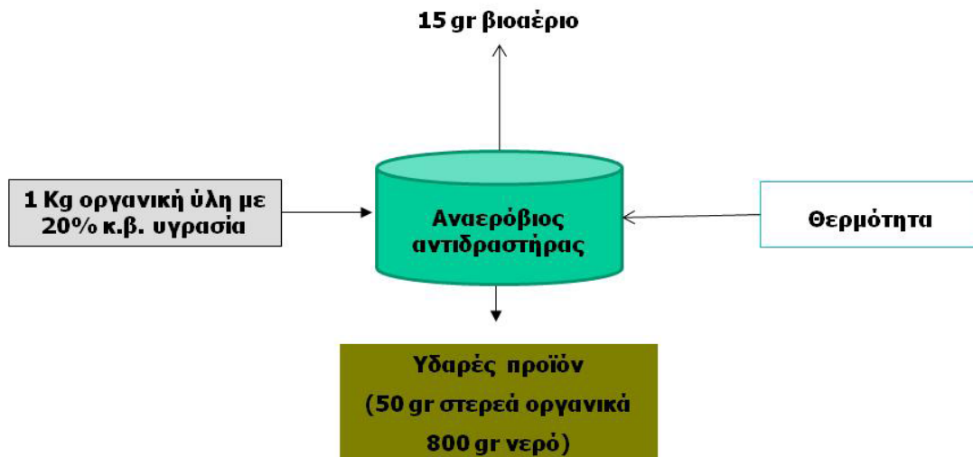
Σχήμα 4.4: Ενδεικτικό ισοζύγιο μάζας αναερόβιας χώνευσης ΑΣΑ. (Πηγή: DEFRA, 2005a)
