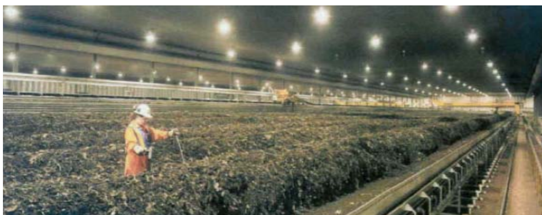
Εικόνα 3.8: Τράπεζα κομποστοποίησης της εταιρίας Bedminster (εδώ χρησιμοποιείται για τη φάση της ωρίμανσης με χρόνο παραμονής 3-5 εβδομάδες)
