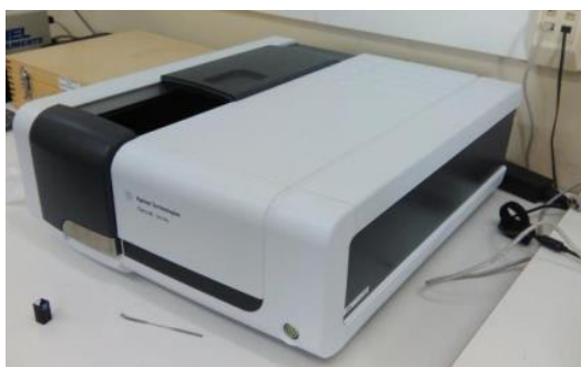
Εικόνα 2.9: Φωτογραφία του φασματόμετρου Agilent Cary 60 UV-vis που χρησιμοποιήθηκε.
