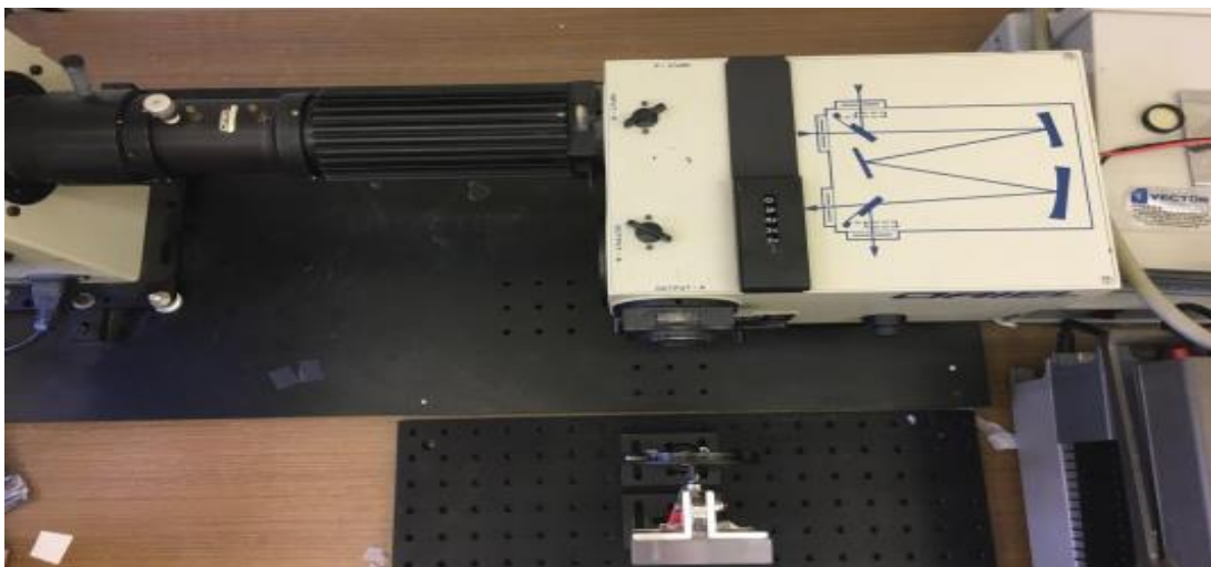
Εικόνα 2.8: Πάνω: Η πειραματική διάταξη με την λάμπα Xe, τον μονοχρωμάτορα Oriiel, το πικοαμπερόμετρο και το στήριγμα με τη βάση για τα δείγματα στην έξοδο του μονοχρωμάτορα Κάτω: Κάτοψη της διάταξης όπου φαίνεται πάνω στον μονοχρωμάτορα σχηματική αναπαράσταση της διαδρομής της ακτινοβολίας με το φράγμα περίθλασης.
