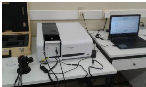
Εικόνα 2.9: Φωτογραφία του φασματόμετρου Agilent Cary 60 UV-vis που χρησιμοποιήθηκε.
