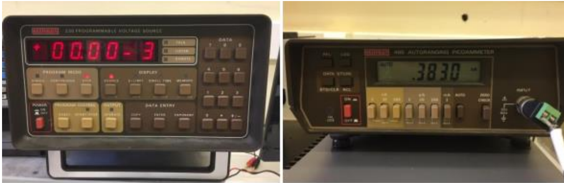
Εικόνα 2.7: Αριστερά: τροφοδοτικό τάσης Keithley model 230. Δεξιά: αμπερόμετρο Keithley model 485
