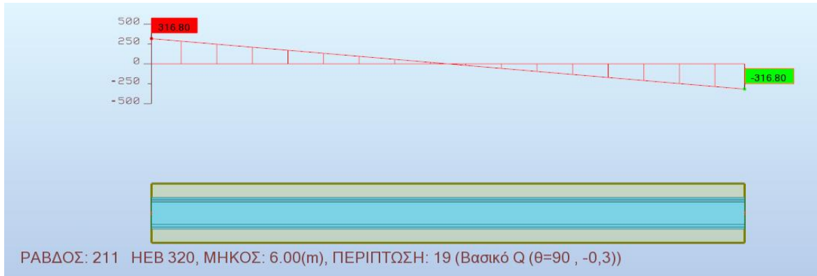
Σχήμα 4.10: Διάγραμμα τεμνουσών δυνάμεων V_{z,Ed}
