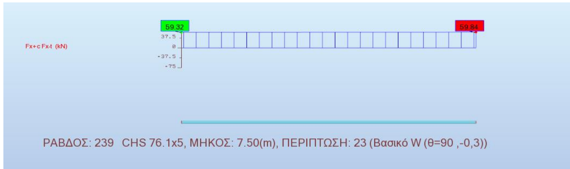
Σχήμα 4.20: Διάγραμμα αξονικών δυνάμεων συνδέσμου δυσκαμψίας 1 ου ορόφου
