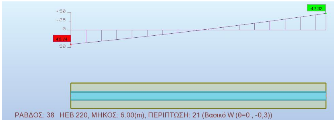
Σχήμα 4.13: Διάγραμμα ροπών κάμψης δυσμενέστερης δευτερεύουσας δοκού
