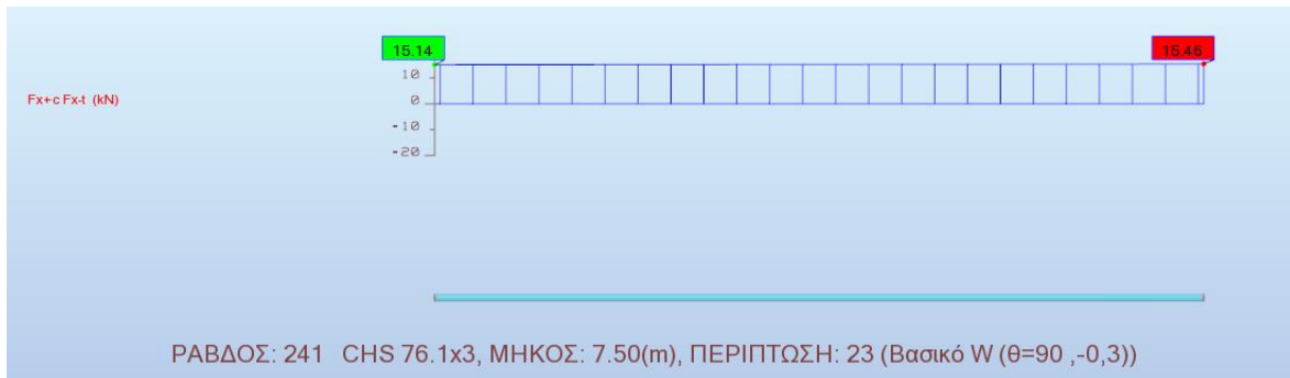
Σχήμα 4.22: Διάγραμμα αξονικών δυνάμεων συνδέσμου δυσκαμψίας 2 ου ορόφου
