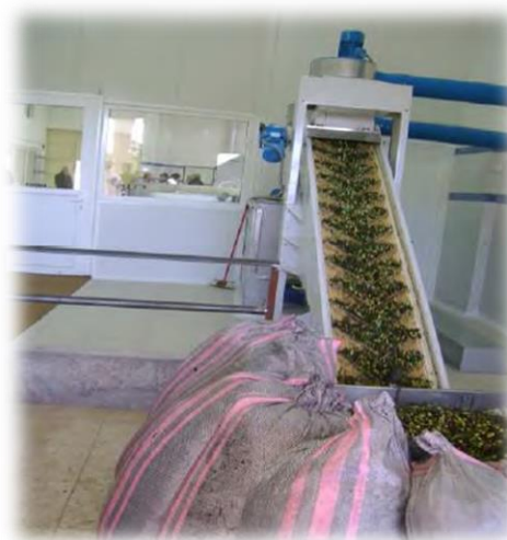
Εικόνα 3 Ταινία μεταφοράς του ελαιόκαρπου
