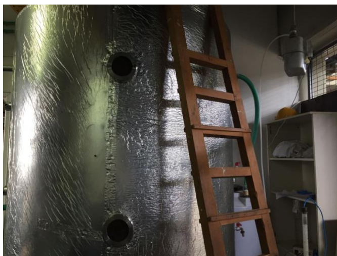
Εικόνα 25 Αντιδραστήρας αναερόβιας χώνευσης οικιακών αποβλήτων
