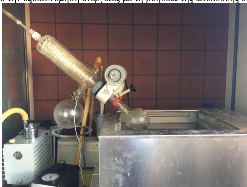
Εικόνα 29. Διάταξη αναγέννησης κορεσμένου ΜΕΑ υπό κενό/Rotary Evaporator
