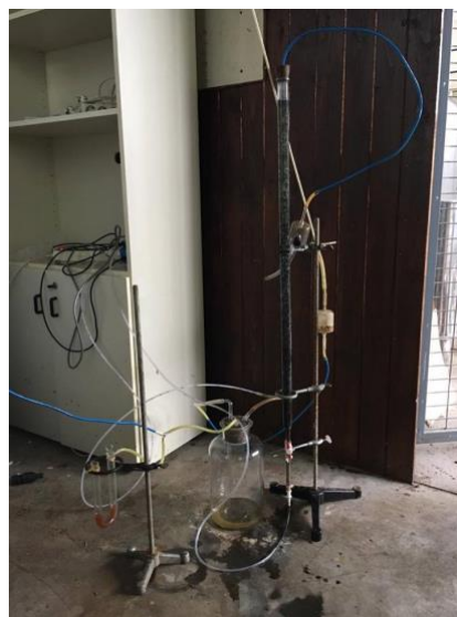
Εικόνα 24 Στήλη αναβάθμισης βιοαερίου (Absorber)
