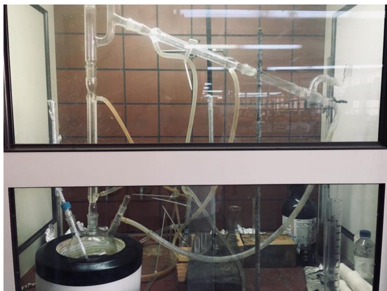
Εικόνα 27 Διάταξη αναγέννησης κορεσμένου MEA
