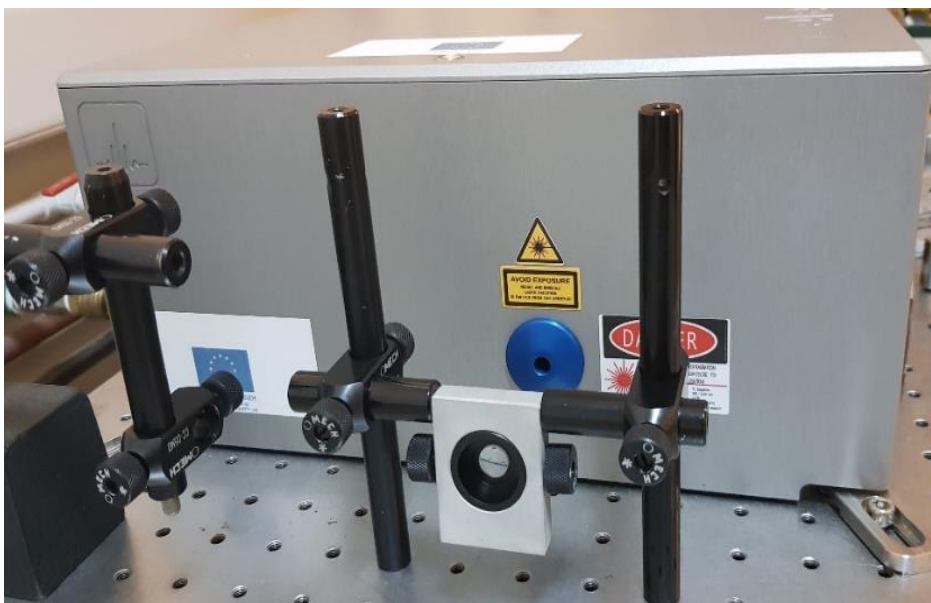
Εικόνα 4.2 Πρόσωση της διάταξης του laser Ti:Sapphire. Η φωτογραφία λήφθηκε λίγο πριν την ακτινοβολήση των κυττάρων.
