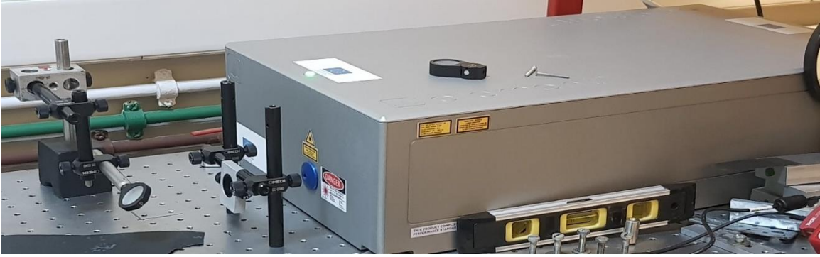
Εικόνα 2.3 Φωτογραφία της διάταξης laser Ti:Sapphire που χρησιμοποιήθηκε στην παρούσα εργασία
