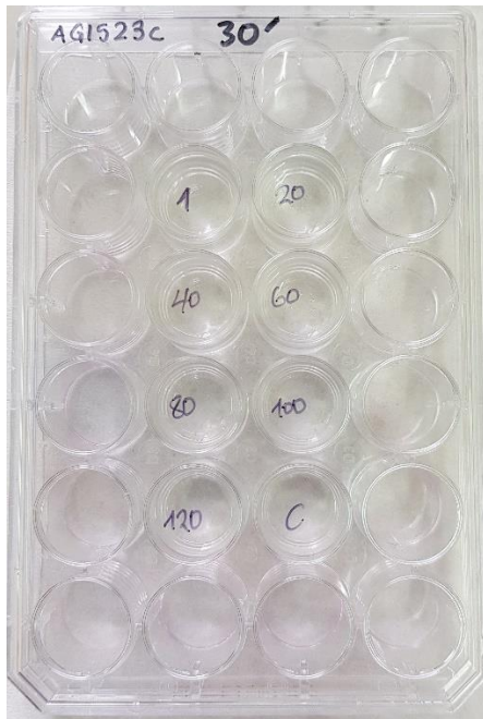
Εικόνα 4.3 Πλάκα καλλιέργειας 24 θέσεων (Greiner). Χρησιμοποιήθηκαν οι κεντρικές 8 θέσεις προκειμένου να προστατευτούν από εξωγενείς παράγοντες.
