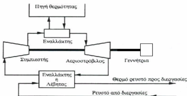
Σχήμα 1. 2 Παράδειγμα κλειστού κύκλου λειτουργίας.
