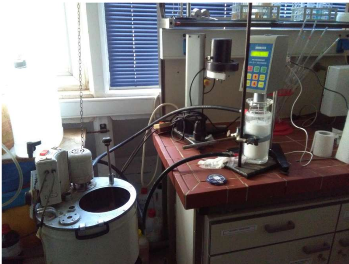
Εικόνα 7.1. Διάταξη μέτρησης ιξώδους με ιξωδόμετρο ομόκεντρων κυλίνδρων
