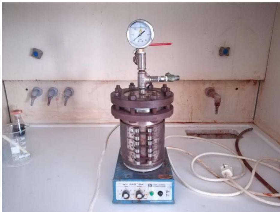
Εικόνα 8.1. Διάταξη παρασκευής οξειδίου του ψευδαργύρου
