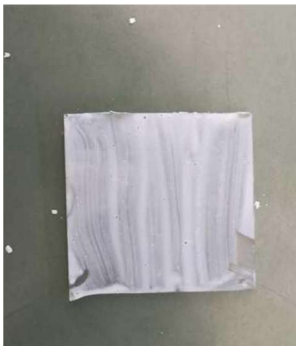
Εικόνα 9.1. Γυάλινο δοκίμιο επικαλυμμένο με γαλάκτωμα PMMA
