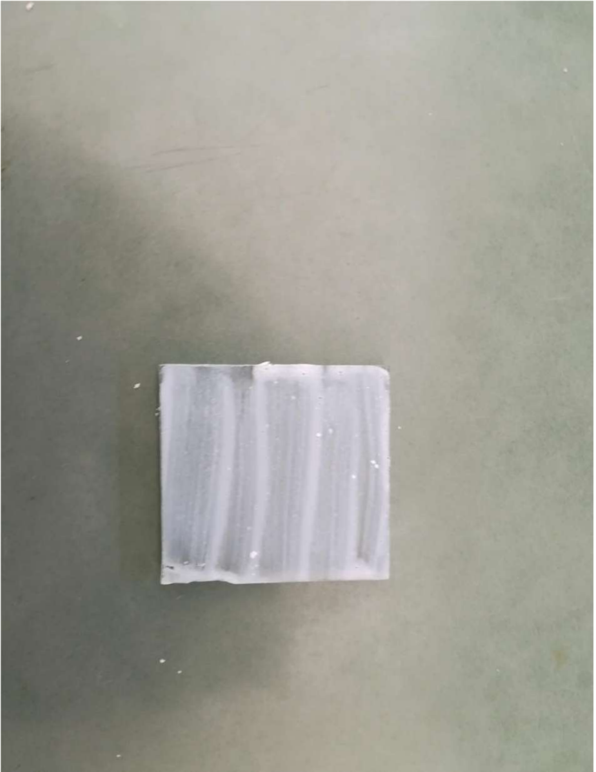
Εικόνα 15. Γυάλινο δοκίμιο επικαλυμμένο από γαλάκτωμα PMMA
