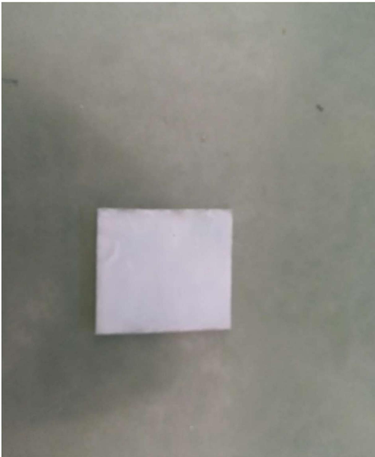
Εικόνα 14. Γυάλινο δοκίμιο επικαλυμμένο από γαλάκτωμα PMMA
