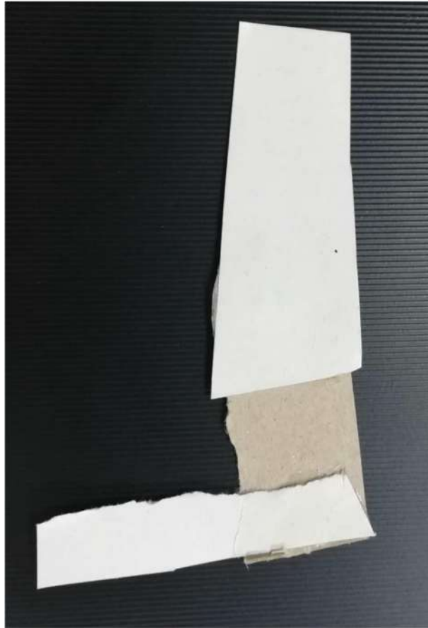
Εικόνα 9.6. Τμήματα χαρτονιού συγκολλημένα με χρήση του υλικού A
