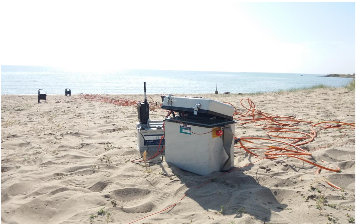
Εικόνα 4.16: Ηλεκτρική τομογραφία (Artec-3) στην περιοχή πλησίον του μικρού ναού
