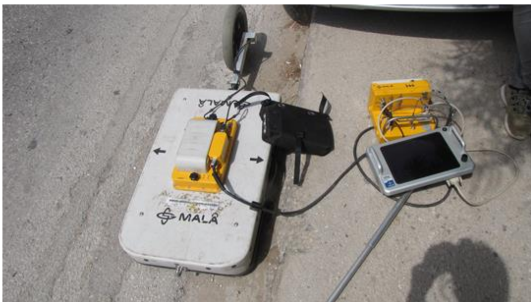
Εικόνα 4.25: Όργανο μετρήσεων GPR
