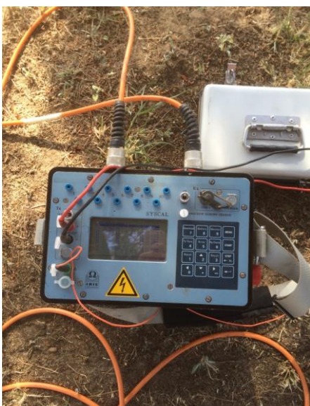
Εικόνα 1.14: α) Όργανο επιλογής της χρησιμοποιούμενης διάταξης β) Όργανο επιλογής της χρησιμοποιούμενης διάταξης και πηγή ηλεκτρικού ρεύματος Πηγή: Προσωπικό αρχείο
