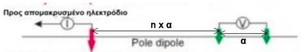
Εικόνα 1.9: Διάταξη Pole-Dipole Πηγή: (Αποστολόπουλος, 2013)
