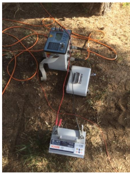
Εικόνα 1.14: α) Όργανο επιλογής της χρησιμοποιούμενης διάταξης β) Όργανο επιλογής της χρησιμοποιούμενης διάταξης και πηγή ηλεκτρικού ρεύματος Πηγή: Προσωπικό αρχείο
