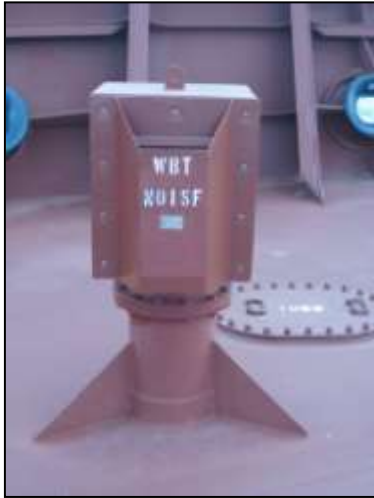
Εικόνα 4.5 Ball Valve Vent Head (αεραγωγός δεξαμενών έρματος) (* )
