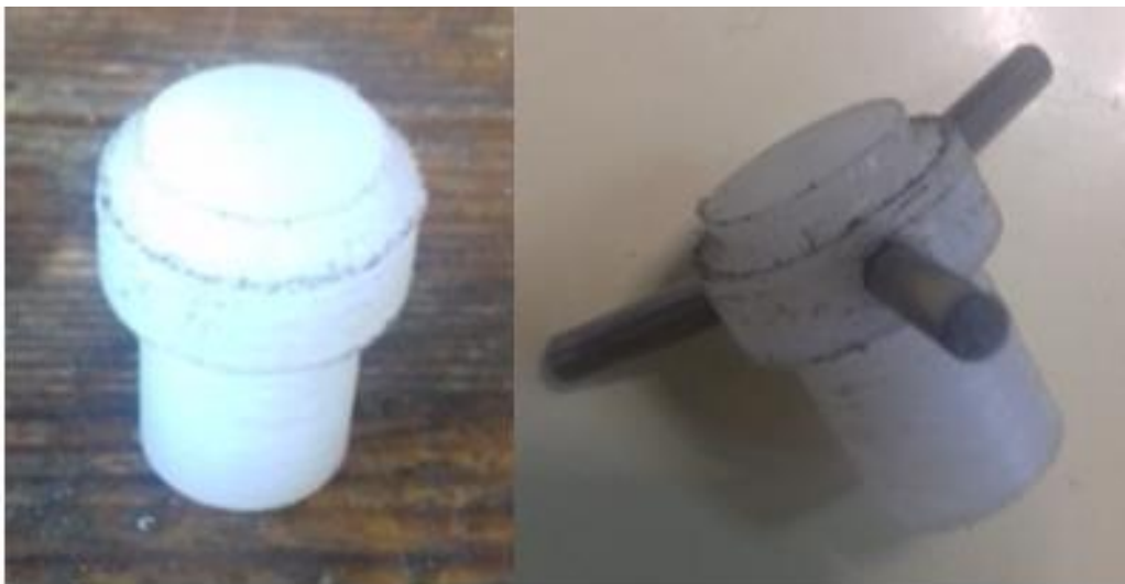
Εικόνα 2.6: Spider χωρίς και με τις ράβδους
