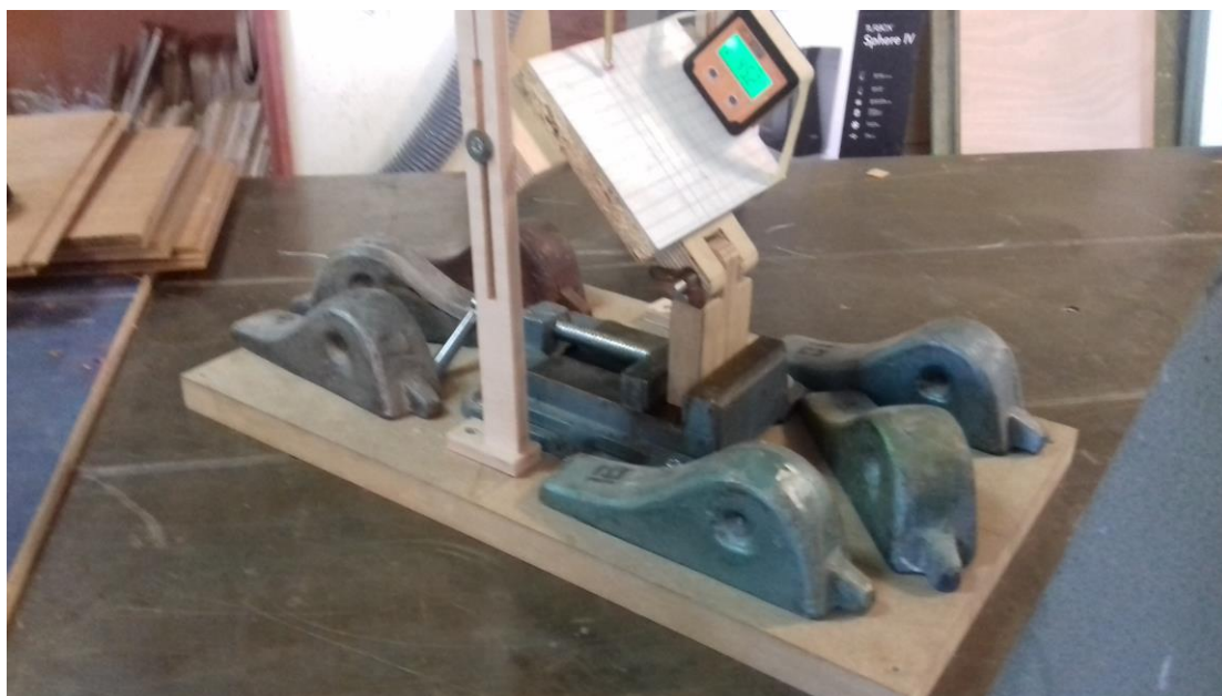
Εικόνα 6.5: Τοποθέτηση διάταξης σε 45 μοίρες ως προς τους άξονες x,y
