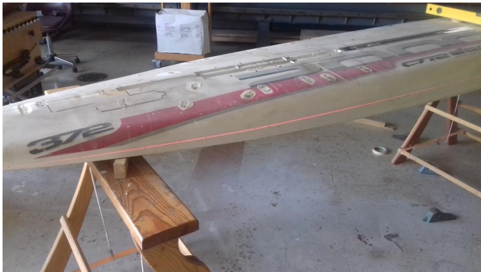
Εικόνα 4.5: laser για το σχεδιασμό ισάλου
