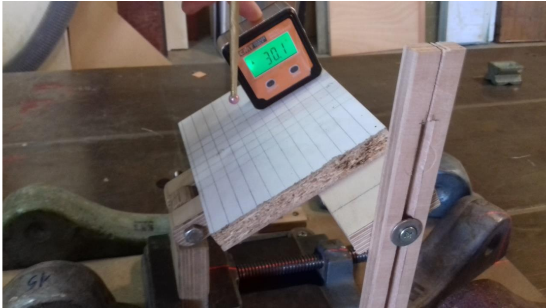
Εικόνα 6.2: Διάταξη πειράματος, με περιστροφή κατά 30 μοίρες
