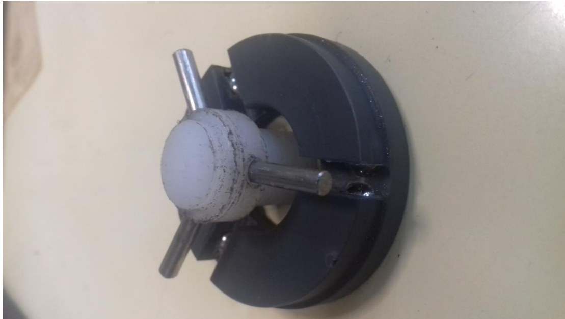
Εικόνα 6.4: Τμήμα του αισθητήρα (spider + Bearing Center))
