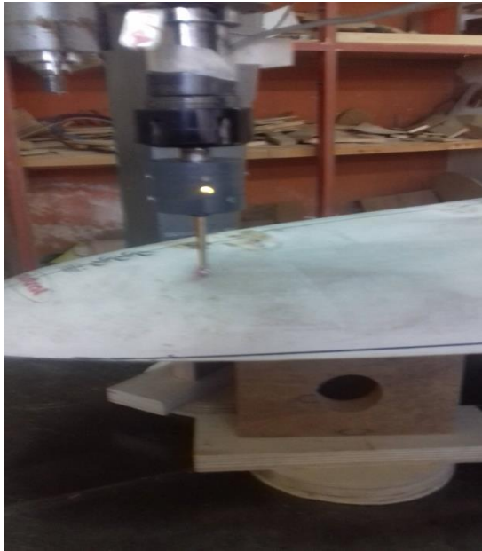
Εικόνα 4.2: Ένδειξη επαφής αισθητήρα με μοντέλο
