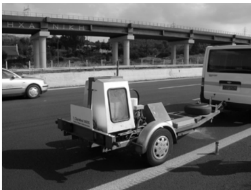
Εικόνα 3.3: Το σύστημα FWD του τομέα ΜΣΥ του ΕΜΠ
