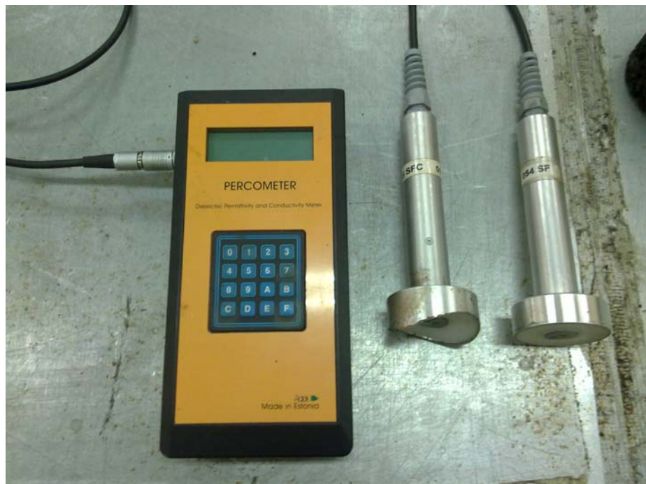
Εικόνα 4.2: Percometer και τύποι ηλεκτροδίων
