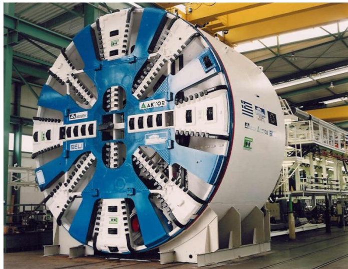
Εικ.2.8: Μηχανή EPB της Επέκτασης του Μετρό προς Ελληνικό (ΑΤΤΙΚΟ ΜΕΤΡΟ Α.Ε.)
