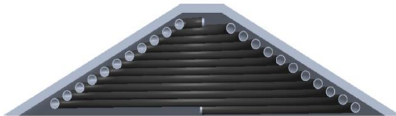
Σχήμα 3.5.18: 3D αναπαράσταση δέκτη κωνικού σχήματος [3.32].
