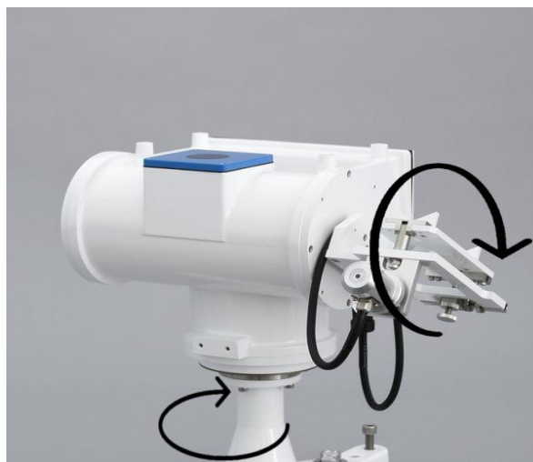
Σχήμα 2.6.4: Συσσκευή παρακολούθησης ηλίου (δύο αξόνων) [2.12].
