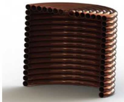
Σχήμα 3.5.5: 3D αναπαράσταση τομής της σωλήνωσης κυλινδρικού δέκτη [3.19].
