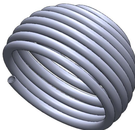
Σχήμα 5.1.30: 3D σχήμα σωλήνα του σφαιρικού δέκτη.
