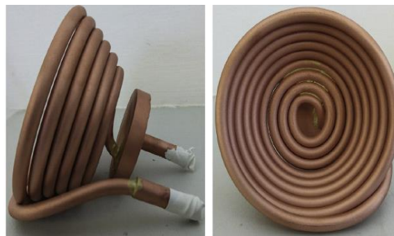
Σχήμα 3.5.9: Σωλήνας δέκτη κωνικού σχήματος [3.24].
