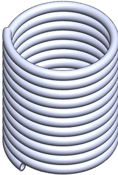
Σχήμα 5.1.2: 3D σχήμα σωλήνα του κυλινδρικού δέκτη.
