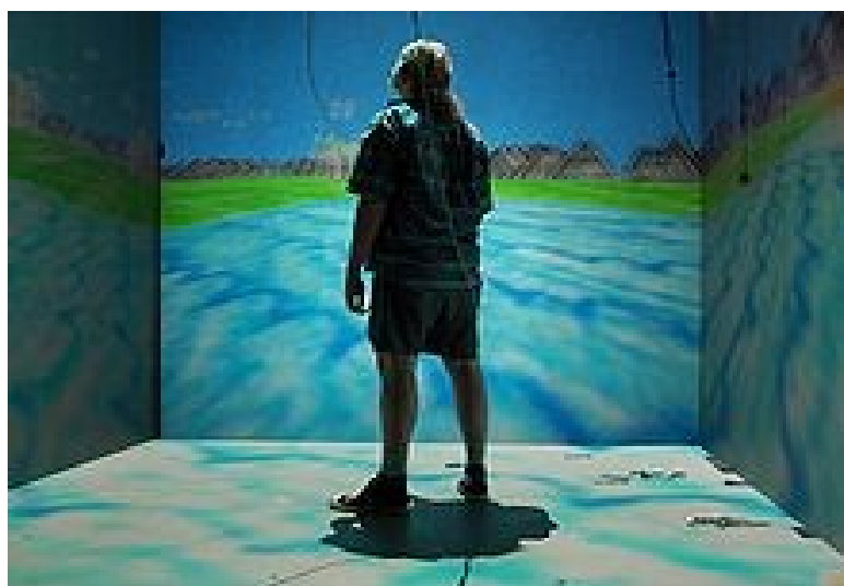
Εικόνα 5: Το σύστημα CAVE. Το δωμάτιο έχει κυβικό σχήμα και προβολείς δείχνουν εικόνες στους τοίχους του.
