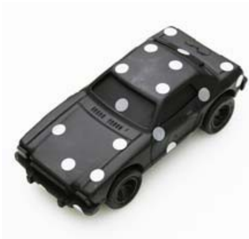
Εικόνα 33: Αντικείμενο με τοποθετημένους δείκτες (markers) στην επιφάνειά του.
