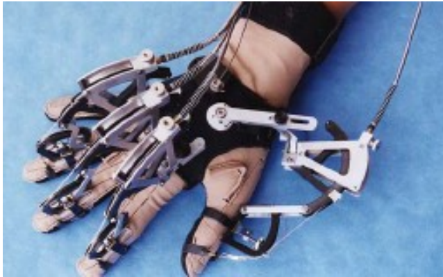
Εικόνα 2: Τα μηχανολογικά εξαρτήματα του απτικού γαντιού χρησιμοποιούνται για την ανίχνευση της κίνησης του χεριού του χρήστη αλλά και για την απόδοση feedback με τη μορφή δυνάμεων ή δονήσεων.
