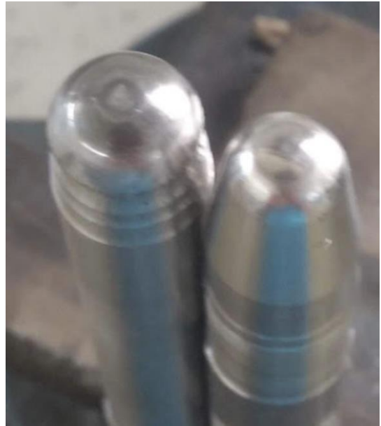
Εικόνα 6-6 Εργαλεία ακτίνας 5mm και 7mm όπου διακρίνονται τα στίγματα από την επαφή
