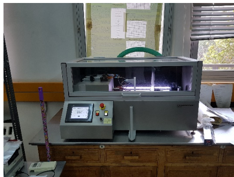
Εικόνα 2-1: Συσκευή Ηλεκτροϋδροδυναμικής διεργασίας- FLUIDNATEK LE-10, Bioinicia.
