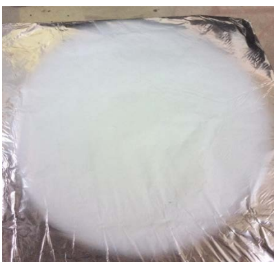
Εικόνα 2-3: Προϊόν ηλεκτροστατικού ψεκασμού πολυμερικού διαλύματος ζεΐνης-Stevia
