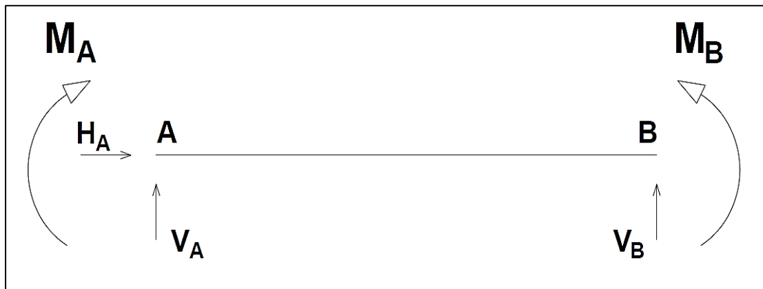
Εικόνα 5.9: Διάγραμμα ελευθέρου σώματος του Reckling No.23
