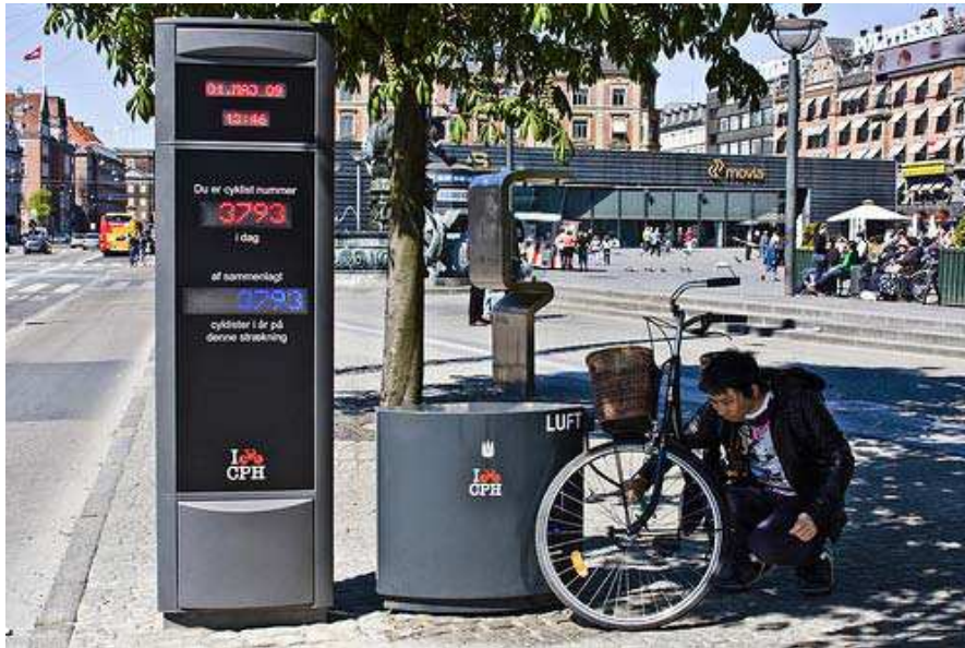
Εικόνα 12, Bicycle Counters , Μετρητές ποδηλάτων στην πόλη της Κοπεγχάγης, που στόχο έχουν την παρακολούθηση της ροής του ποδηλατικού δικτύου της πόλης
