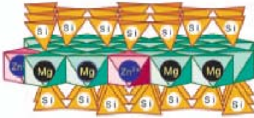
Εικόνα 2.12: Υποκατάσταση Mg από Zn.
