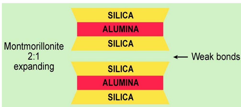
Εικόνες 2.19: Δεσμοί “ van deer waals ” σε ορυκτά δομής 2:1.
