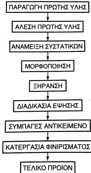
Σχήμα 1.3 Στάδια παραγωγής κεραμικών προϊόντων [7]
