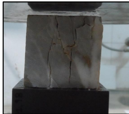
Φωτ. Α.9: Μετά τη δοκιμή θλίψεως.
