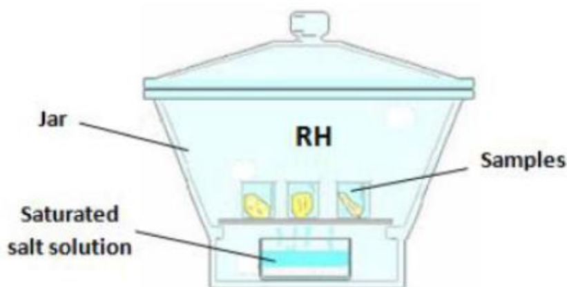
Σχήμα 21. Σχηματική αναπαράσταση γυάλας αποθήκευσης των δοκιμών για την επίτευξη της επιθυμητής σχετικής υγρασίας. (23)
