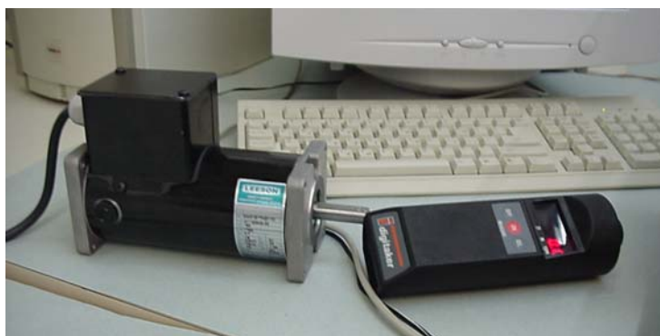
Εικόνα 39. Ηλεκτροκινητήρας χωρίς μειωτήρα στροφών και οπτικό ταχύμετρο.
