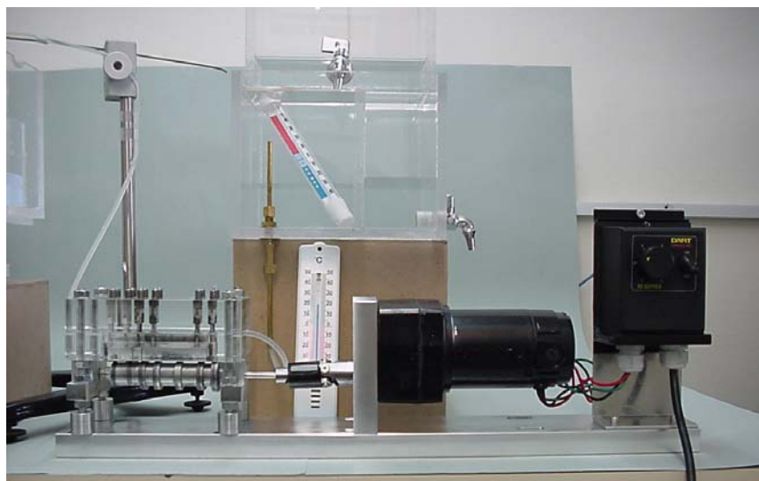
Εικόνα 34. Η μεταλλική βάση, ο ηλεκτροκινητήρας με το ηλεκτρονικό σύστημα οδήγησης, η περισταλτική αντλία και ο αρθρωτός σύνδεσμος.
