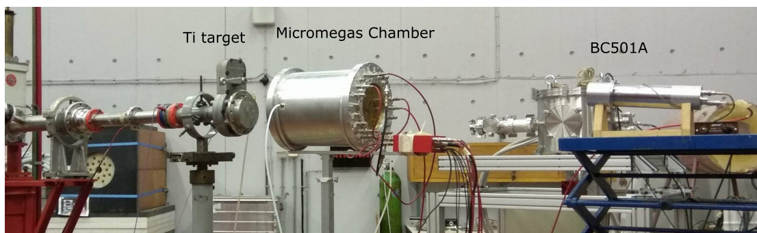
Εικόνα 2.24: Η πειραματική διάταξη με το στόχο τριτίου, το δοχείο με τους ανιχνευτές Micromegas και ο σπινθηριστής
