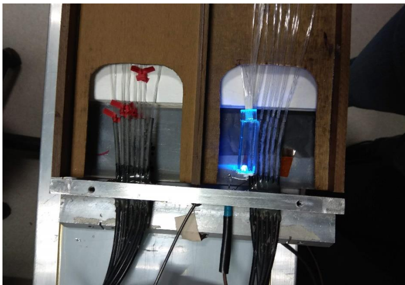
Εικόνα 41: Εμπρόσθιο μέρος κουτιού αποθήκευσης των δεκατριών σπινθηριστών. Δεξιά φαίνεται το LED, το οποίο συνδεδεμένο με τάση περίπου 5V, άναβε προκειμένου να δοκιμαστούν οι σπινθηριστές. Αριστερά φαίνεται η έξοδος. Στο άκρο των κυματοδηγών διακρινόταν πράσινο φως.
