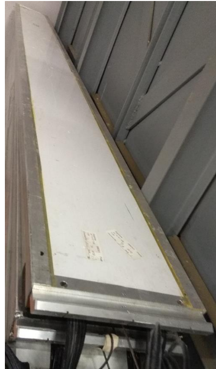
Εικόνα 42: Το κουτί που φιλοξενούσε τους 13 φωτοπολλαπλασιαστές, αριστερά ανοιχτό και δεξιά κλειστό με το αλουμινένιο περίβλημα.
