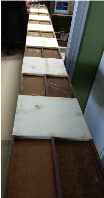
Εικόνα 42: Το κουτί που φιλοξενούσε τους 13 φωτοπολλαπλασιαστές, αριστερά ανοιχτό και δεξιά κλειστό με το αλουμινένιο περίβλημα.
