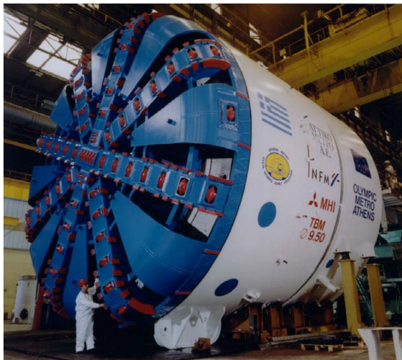
Εικόνα_2.4: Μηχάνημα TBM - ολομέτωπης κοπής που χρησιμοποιήθηκε για τη διάνοιξη του μετρό της Αθήνας ( http://www.ametro.gr/page/default.asp?la=1&id=26 )
