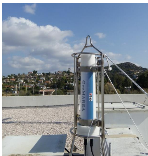
Σχήμα 2.4: Το ανιχνευτικό σύστημα GeoMAREA τοποθετημένο στην οροφή του ΕΛ.ΚΕ.Θ.Ε.
