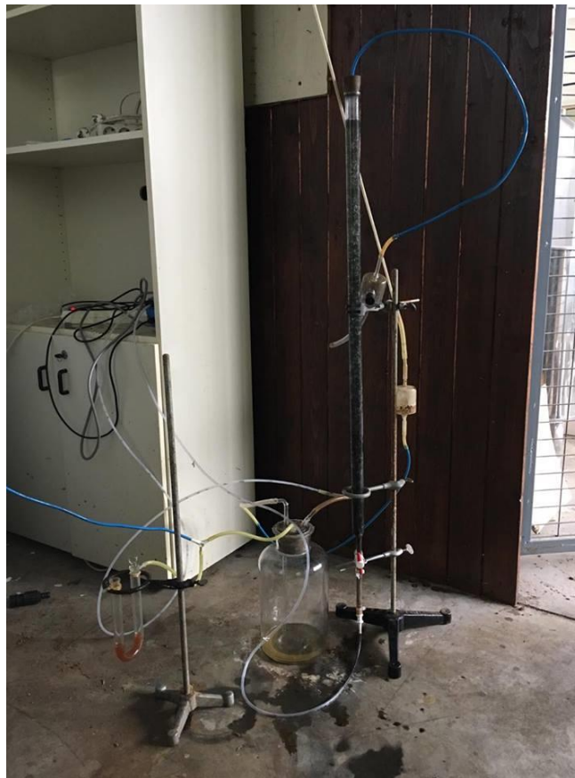
Εικόνα 18. Στήλη απορρόφησης εργαστηριακής κλίμακας για την αναβάθμιση του βιοαερίου (Absorber)
