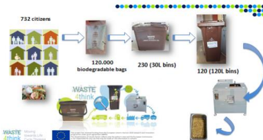
Εικόνα 17. Διαδικασία παραγωγής FORBI από προδιαλεγμένα οργανικά υπολείμματα τροφής
