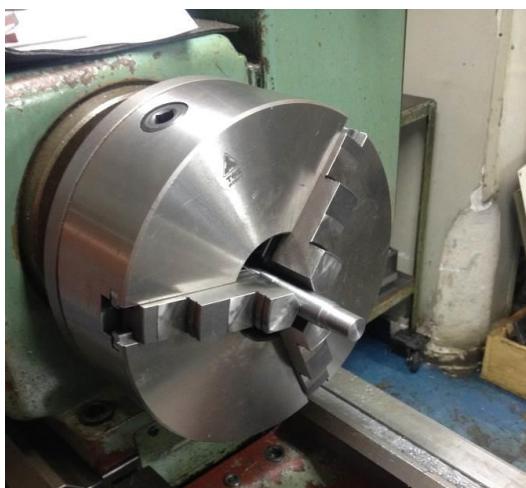
Εικόνα 9.6: Η κατασκευή του άξονα της διάταξης στον τόρνο
