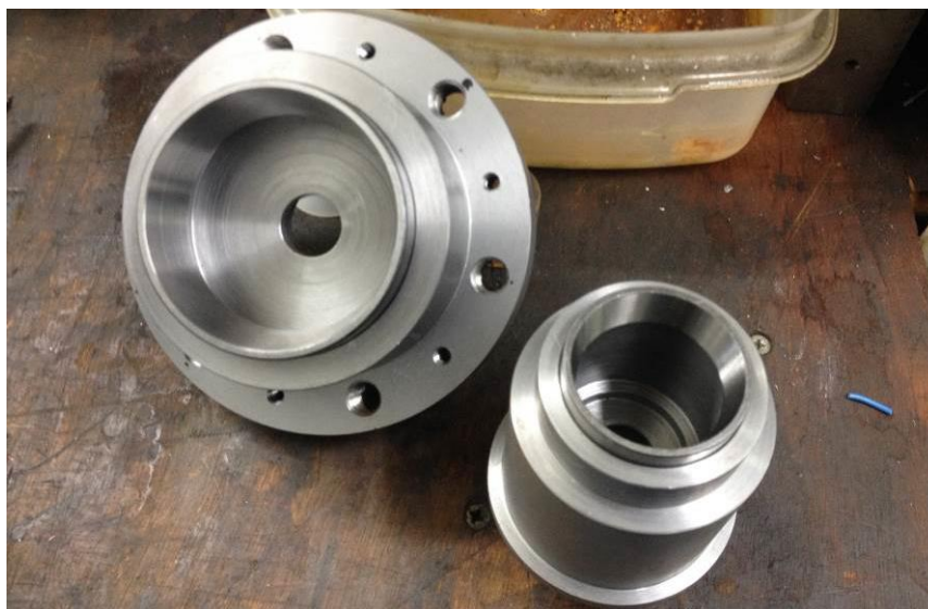
Εικόνα 9.9: Οι εξωτερικοί δακτύλιοι των ρουλεμάν οδηγούμενοι από της διαμέτρους μεγαλύτερης διαστασιολογικής ανοχής
