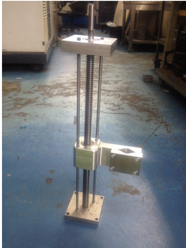
Εικόνα 10.12: Διάταξη Holder με την προσθήκη των διαγώνιων χαλύβδινων αξόνων οδήγησης
