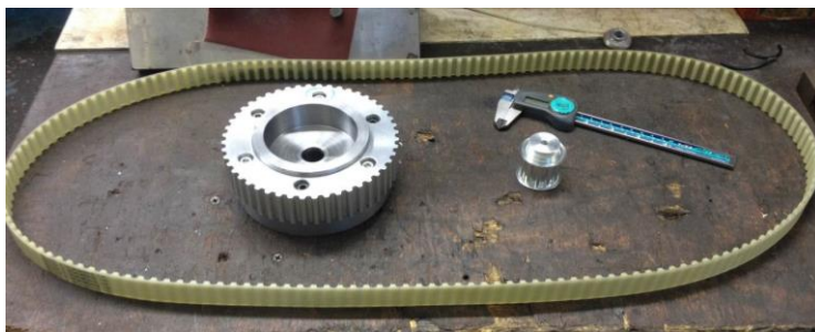
Εικόνα 7.3: Αριστερά η τροχαλία 48 οδόντων συναρμολογημένη στη βάση της Πλατφόρμας Δεξιά η τροχαλία 12 οδόντων
