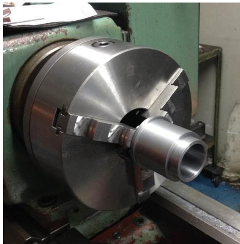
Εικόνα 9.5: Η κατασκευή της βάσης της διάταξης περιστροφής σε τόρνο
