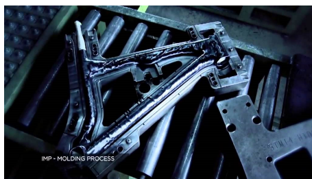
Σχήμα 2.8: Μήτρα ειδικά κατασκευασμένη για σκελετό ποδηλάτου
