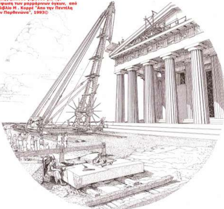
Εικόνα 5: Αναπαράσταση χρήσης ξύλινου γερανού για ανύψωση μαρμάρινων όγκων κατά την αρχαιότητα
