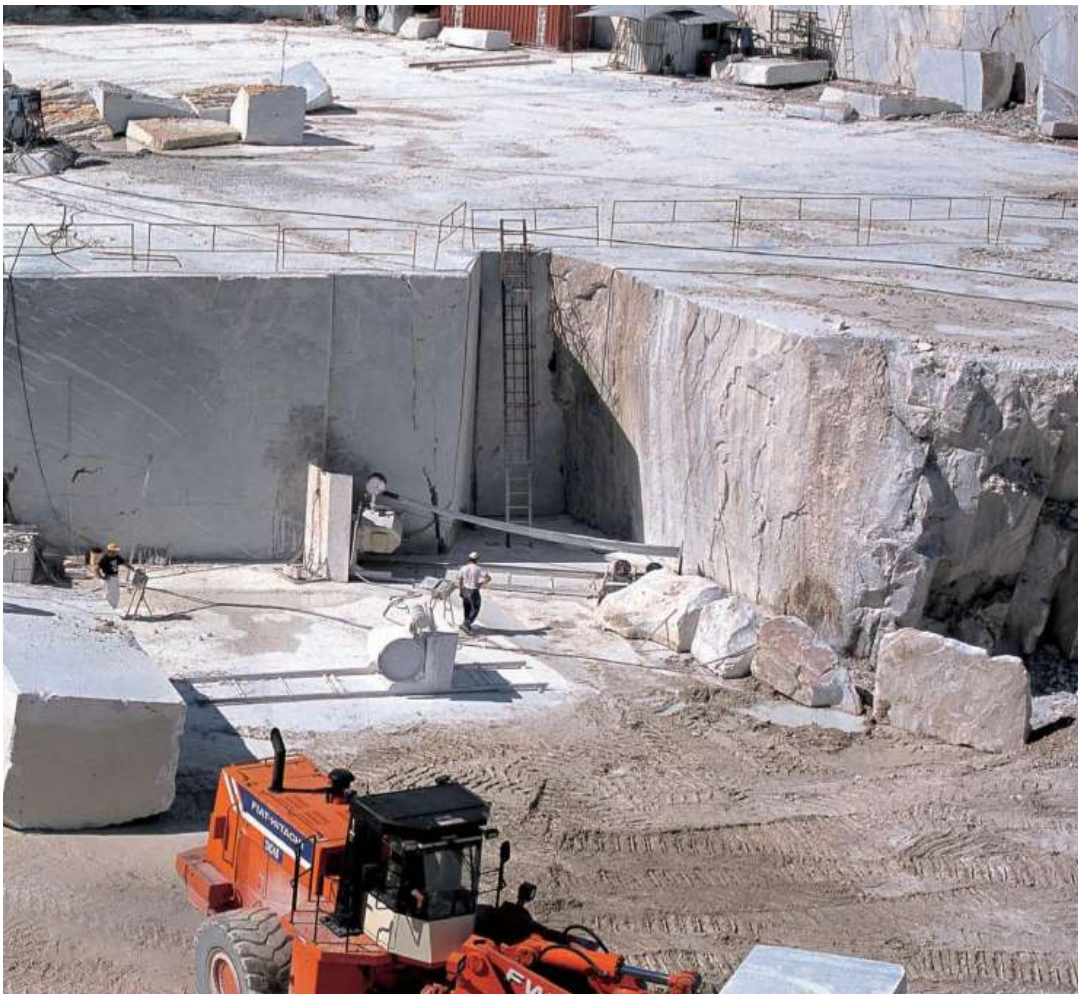
Εικόνα 9: Αναπτυγμένα μέτωπα εξόρυξης σε λατομείο μαρμάρου
