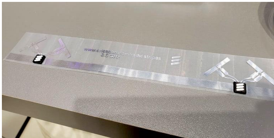
Εικόνα 2.5: Τμήμα της ταινίας που περιλαμβάνει κεραιές για την διάδοση συχνοτήτων 3.5 GHz, Πηγή: Jeremy Kaplan / Digital Trends
