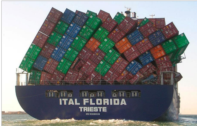
Σχήμα 2.11 : Μετατόπιση εμπορευματοκιβωτίων λόγω έντονων κυματισμών
