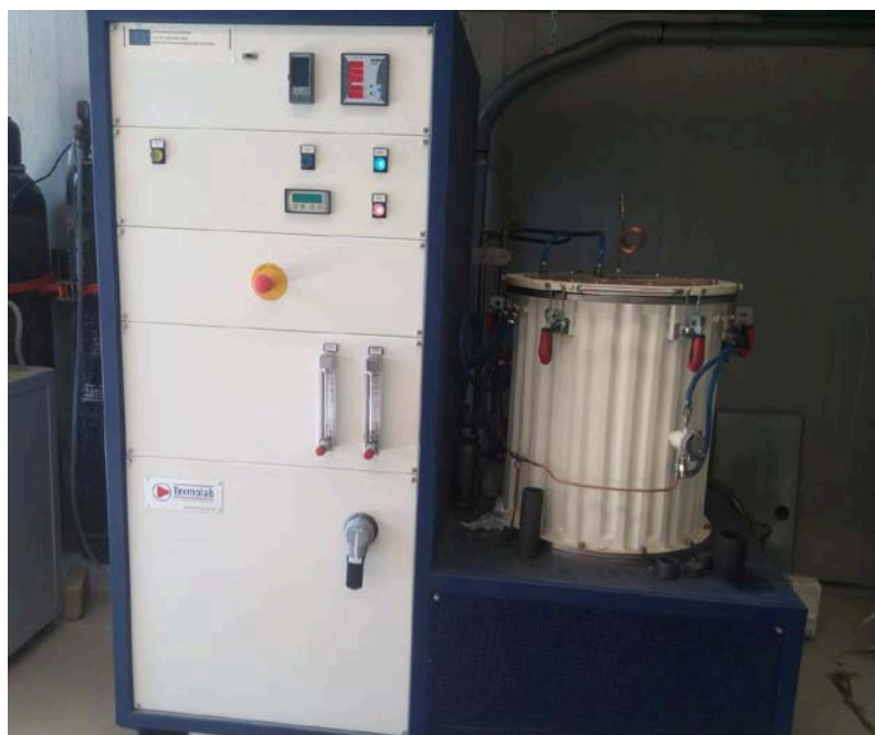
Εικόνα 5.7. Εργαστηριακή κάμινος κενού Termolab του Εργ. Μεταλλουργίας ΕΜΠ
