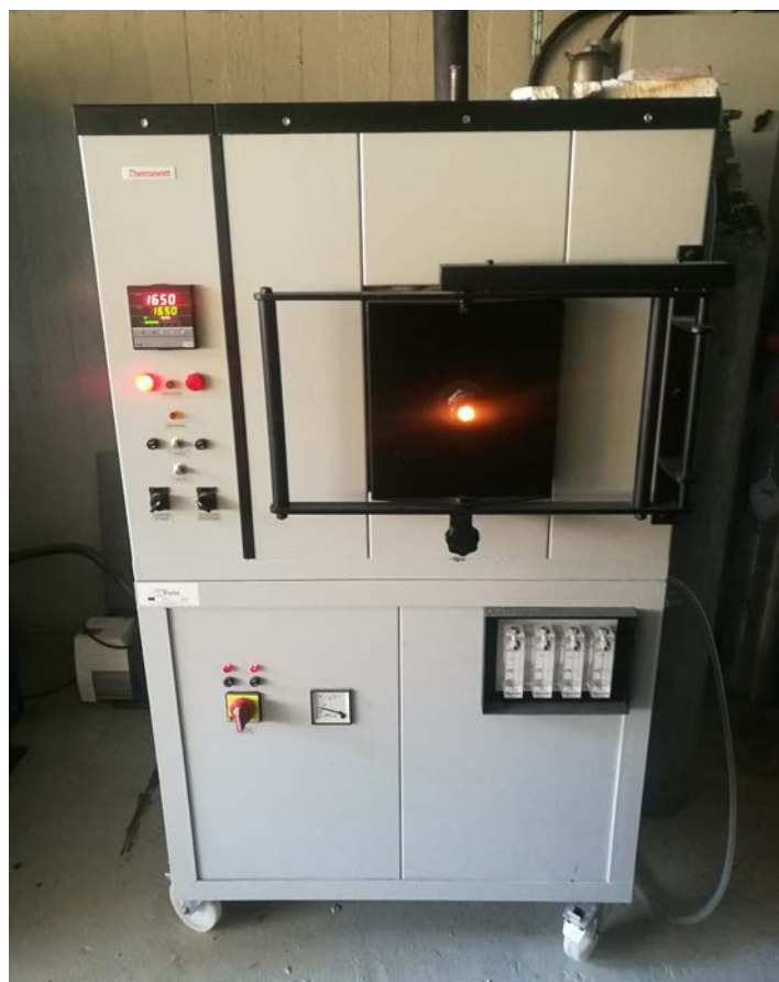
Εικόνα 5.6. Εργαστηριακή κάμινος αντίστασης Εργ. Μεταλλουργίας ΕΜΠ
