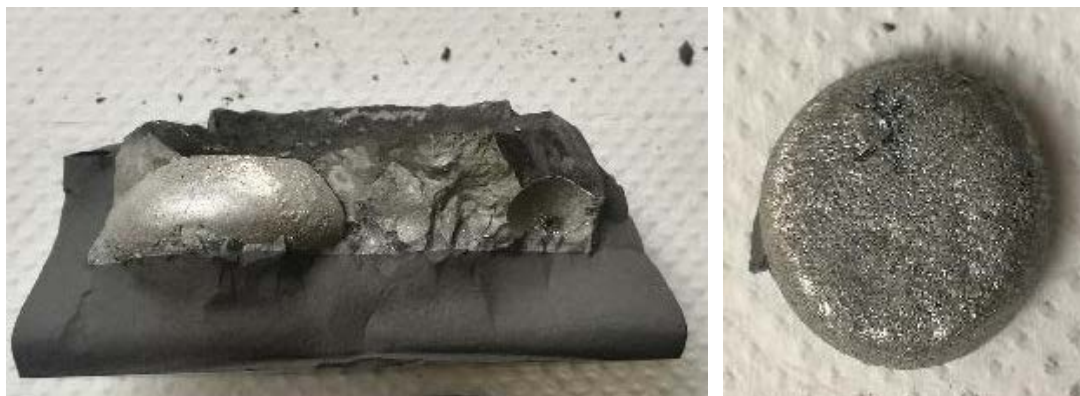
Εικόνα 5.16. Χωνευτήριο με τη σκωρία και το μέταλλο (αριστερά) και μέταλλο (δεξιά) της δοκιμής 7.
