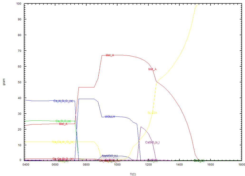
Σχήμα 5.12. Σταθερότητα φάσεων της σκωρίας με προθήκη επιπλέον 10 g SiO 2 σε συνάρτηση με τη θερμοκρασία της
