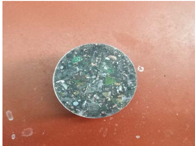
Εικόνα 5.2. Εγκιβωτισμένο δοκίμιο πλακετών τυπωμένου κυκλώματος προς εξέταση στο SEM
