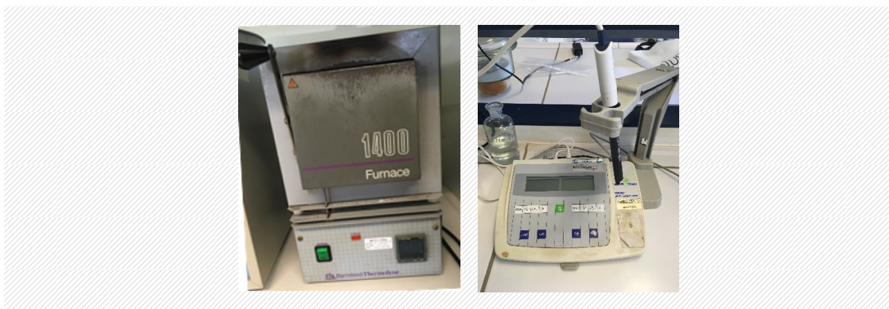
Εικόνα 5-10: Αριστερά: Φούρνος μέτρησης πηητικών στερεών — Δεξιά: Πεχάμετρο Mettler Toledo MPC227
