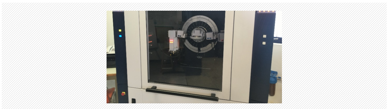
Εικόνα 5-14 (αριστερά): Το περιθλασίμετρο X-ray diffraction)η XRD D8 Advance της Bruker [80].
