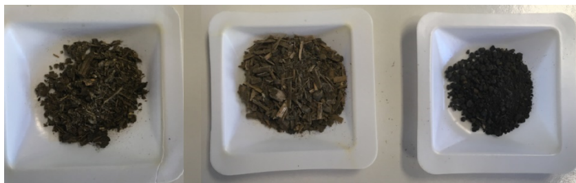
Εικόνα 7-1: Τα τρία στερεά που χαρακτηρίστηκαν με περίθλαση ακτίνωνΧ, από αριστερά προς τα δεξιά ξηραμένη αναερόβια σταθεροποιημένη ιλύς, ξηραμένη ιλύς μετά από προεπεξεργασία με NaOH, ξηραμένη ιλύς μετά από ενζυμική υδρόλυση.
