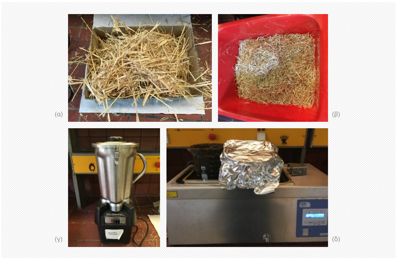
Εικόνα 5-2: (α) Άχυρο προ επεξεργασίας, (β) Άχυρο έπειτα από μηχανική επεξεργασία, (γ) Συσκευή mixer, Commercial Heavy Duty Blender, (δ)
