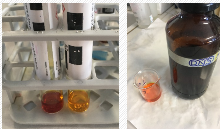
Εικόνα 5-12: Μέτρηση κυτταρίνης με αντιδραστήριο DNS
