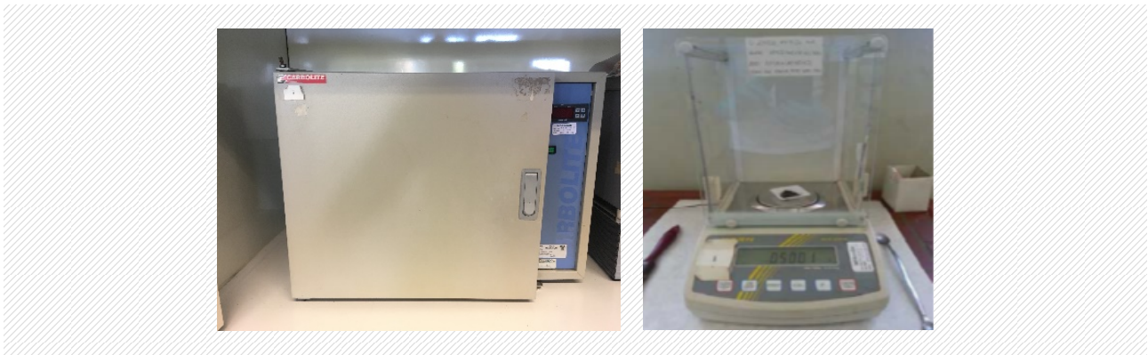
Εικόνα 5-9: Αριστερά: Φούρνος ξήρανσης με ρεύμα αέρα 105°C. — Δεξιά: Ζυγός ακριβείας 4 δεκαδικών ψηφίων.
