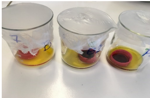
Εικόνα 7-2: Δείγματα που προετοιμάστηκαν για τον προσδιορισμό της αιθανόλης: αριστερά το τυφλό δείγμα και δεξιά δύο δείγματα με υδρολυμένο βιοαπόβλητο ύστερα από ζύμωση. Παρατηρείται ο χαρακτηριστικός πρασινωπός χρωματισμός του όξινου διχρωμικού διαλύματος στον πυθμένα του δοχείου, που αποδίδεται στην απορρόφηση της αιθανόλης και οξειδωσή
