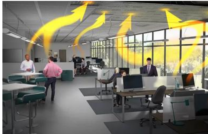
Εικόνα 4.7: Γραφείο με PCM στην οροφή / απορρόφηση θερμότητας
