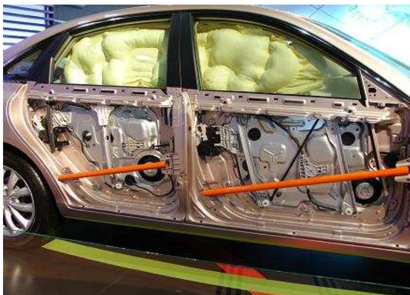
εικόνα 3 3: Πλευρικές μπάρες ασφαλείας από χάλυβα DP
